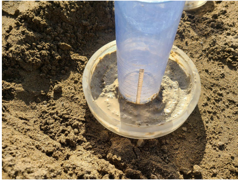
(6) -3: 止水材への吸水・押し固めの完了時の状況
