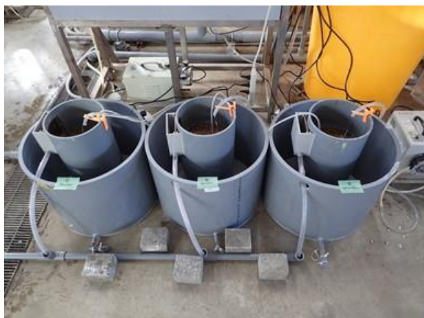
写真-1 完全混合型微生物保持担体処理槽
