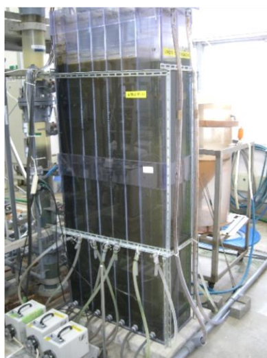
写真-3 簡易沈殿処理装置の写真
