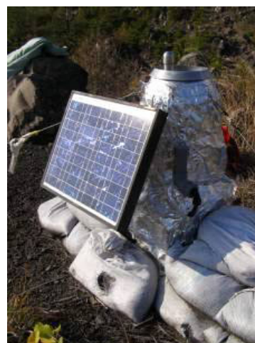
写真 1 自動降灰量計の外観
