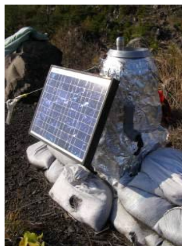
写真 1 自動降灰量計の外観
