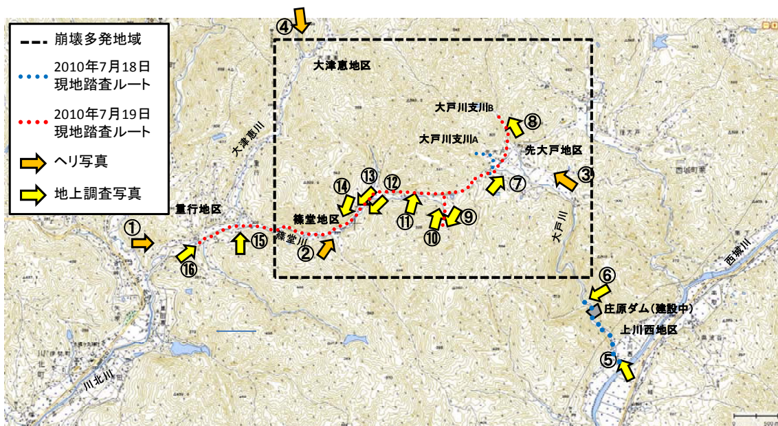
図3 現地踏査ルートおよび後掲写真の位置。破線は図2に示した崩壊多発地域である。7月18日は大戸川流域下流域上川西地区および上流域先大戸地区を調査した。7月19日は大戸川上流域の先大戸地区の土石流が発生した2溪流および先大戸地区から篠堂（しのどう）川に沿って大津恵川合流点付近までを調査した。背景図には国土地理院電子国土を使用した。
