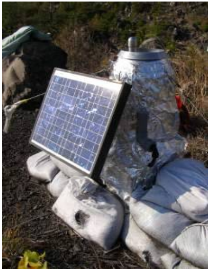
写真1 自動降灰量計の外観
