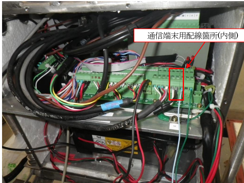
図 7 超小型携帯通信端末への出力ケーブル配線箇所
