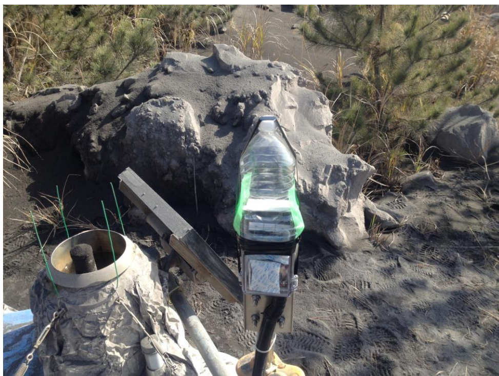
図 11 プラスチック製容器及び外被がかぶされた超小型通信端末
