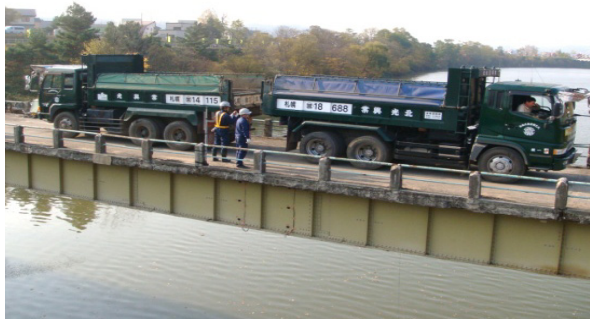
荷重車を用いた現地載荷試験
