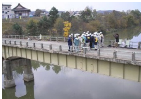
人力加振による振動試験
