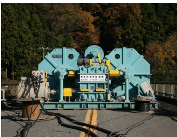
起振機による振動試験
