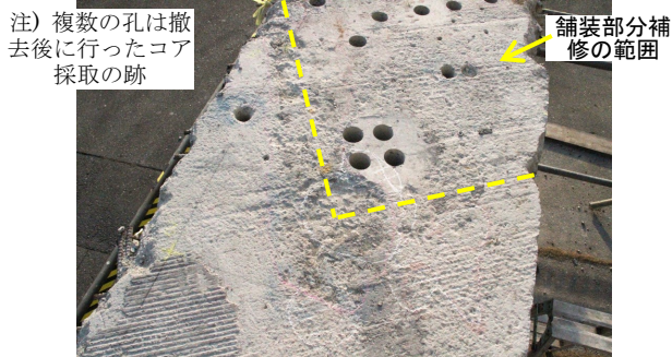
図-5 防水層下の土砂化の事例 (T 橋)
