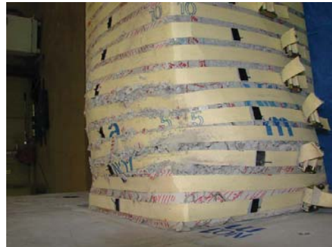
土木研究所CAESARで研究開発した機械式定着繊維バンドによるRC橋脚の応急復旧技術
