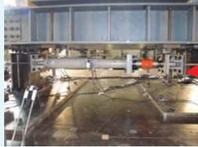
振動実験による制震ダンパーの性能試験
