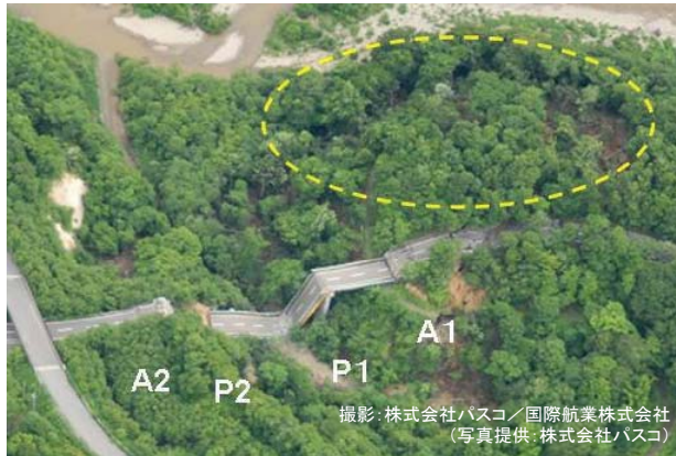
地すべりに伴って移動した下部構造と落橋した桁 (2008年岩手・宮城内陸地震)
