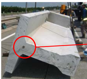
床版付近の曲げ上げ部でグラウト未充填部を確認
