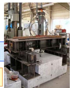
あと施工アンカーの引抜き試験
