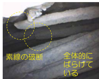
例②：大部分の素線の破断
