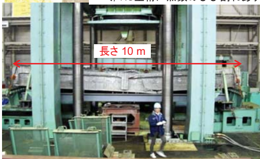
載荷試験後の破壊状況 (全景, 最大荷重53トン)
