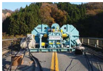
起振機による振動試験
