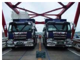
荷重車載荷試験
