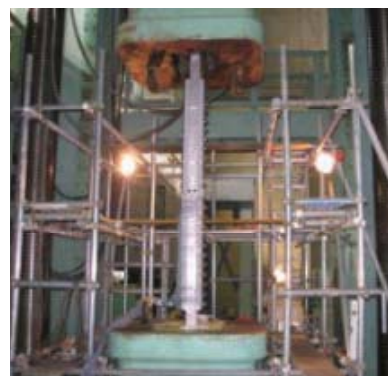
厚板鋼板高力ボルト摩擦接合 継手のすべり耐力試験
