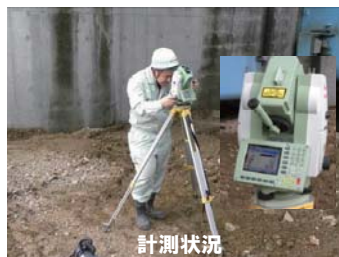
幅計測時にレンズを覗いた状況
