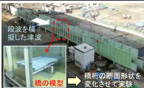
上部構造の断面特性が津波を受けた時の支承部に及ぼす影響に関する水路実験
