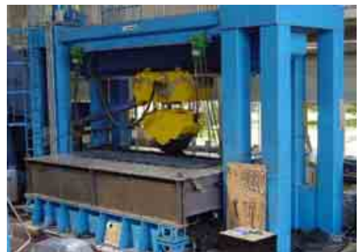
実大試験体を用いた輪荷重走行疲労試験
