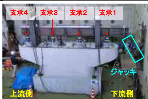
4主桁橋における1支承線全体としての抵抗特性に関する静的載荷実験
