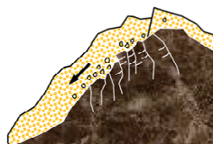
風化層のすべり・崩壊
