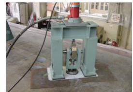
現場個別条件下での引張試験
