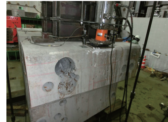
縁端拡幅部の載荷試験の状況
