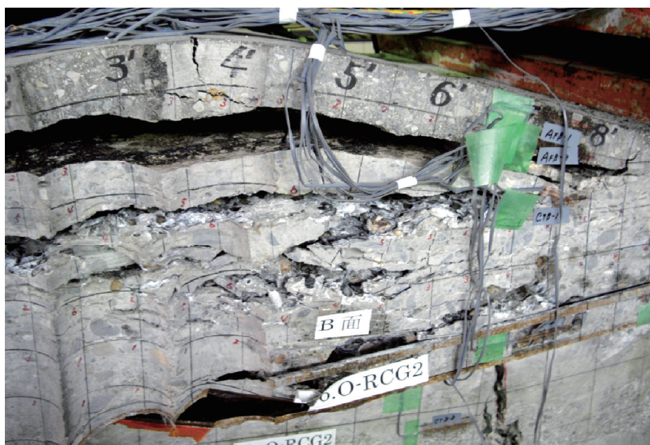
圧壊付近の上フランジ側面の状況
