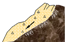
崩壊土のすべり・崩壊
