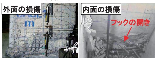
＜例＞中空断面橋脚の最終的な破壊形態
