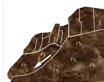
下部の脆弱層の変形による 岩盤の変形・崩壊
