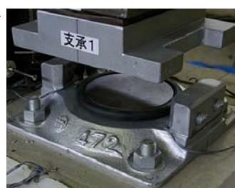
上部構造が流出した小泉大橋における鋼製支承の破壊モード
