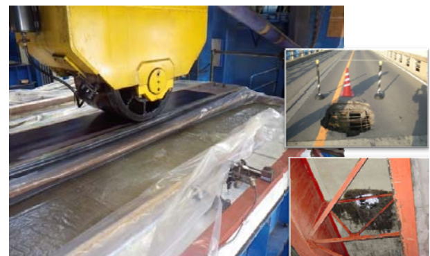
RC床版の輪荷重走行試験
