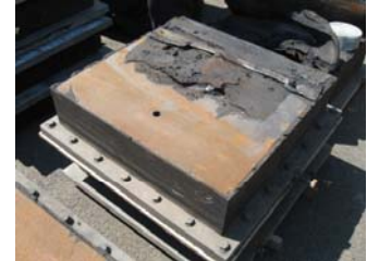
橋梁から取り外した 後のゴム支承破断 面の状態
