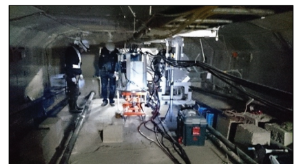
箱桁内のX線源設置の様子
