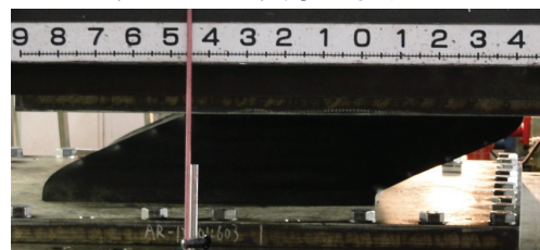
300%ひずみのゴム支承の状況
