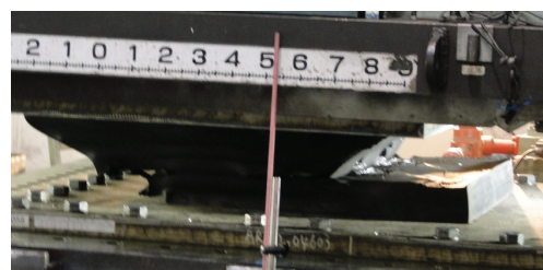
破断時のゴム支承の状況
