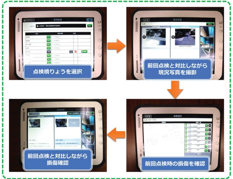
タブレットを用いた点検の効率化
