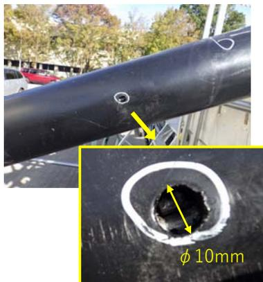
※写真は側面に設置した計測孔のもので、模擬損傷は下部に削孔する。
