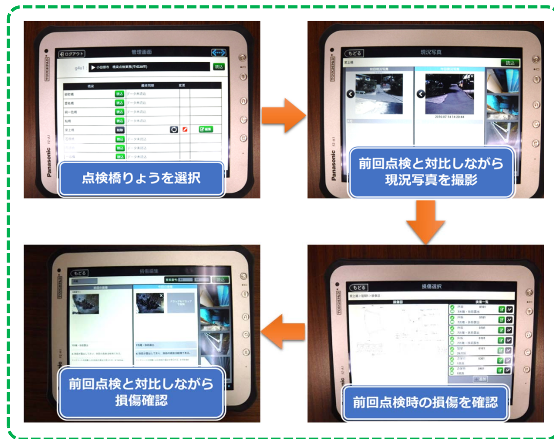
タブレットを用いた点検の効率化
