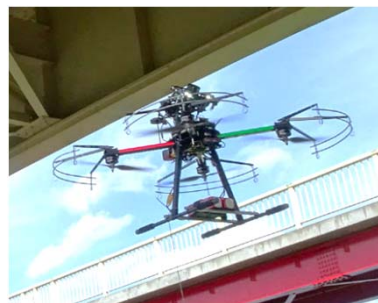
▲橋梁の損傷写真を撮影する技術
