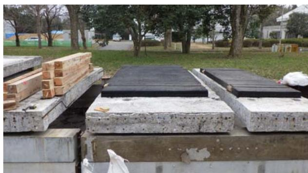
土砂化した床版面に舗装を設置
