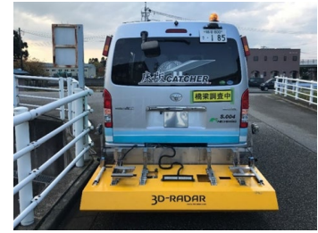
電磁波レーダーによる滞水の有無、漏水経路の探査
