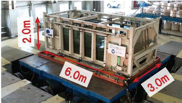
三次元大型振動台と大型剛土槽
