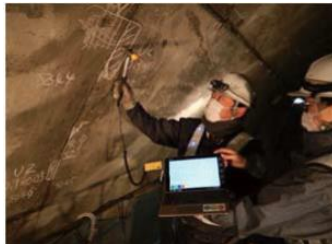
打音ハンマーによる打撃波形からAIにより打音異常を判定
