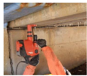
塩化物イオン測定のための、削孔による試料採取
