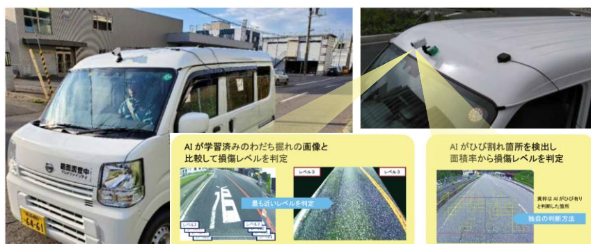
<掲載技術名>汎用機材を用いたAI舗装損傷診断システム(マルチファインアイ) (検出項目:ひび割れ率)
