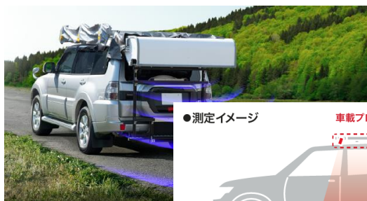
<掲載技術名>路面モニタリングシステム (検出項目:ひび割れ率、わだち掘れ量、IRI)
