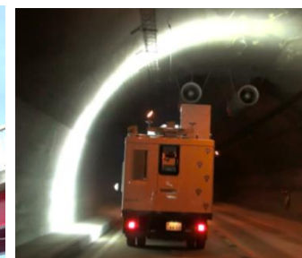
▲トンネルの変状写真を撮影する技術 (MIMM(ミーム))
