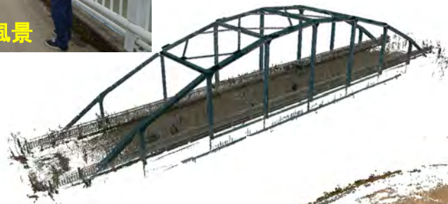
トラス上部構造の点群モデル
