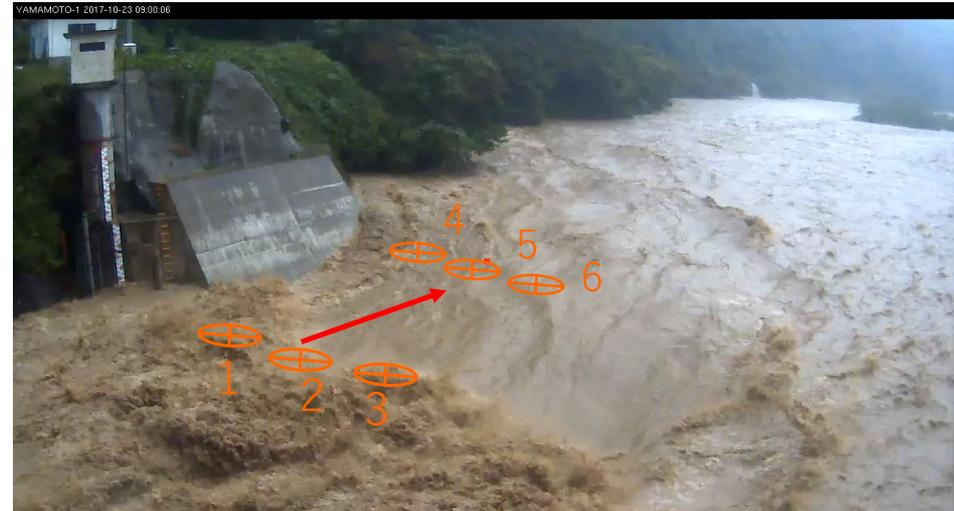
流れの変化⇒計測点変更の必要性
