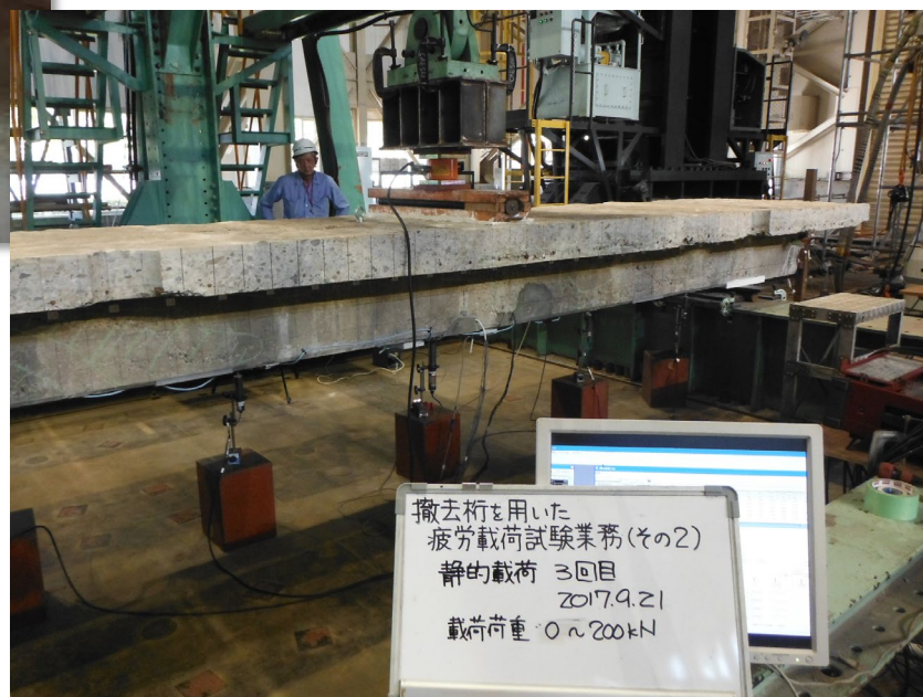
老朽化により撤去されたRCT桁の疲労載荷試験
