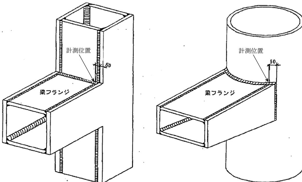
注：隅角部の溶接線端部から 50mm 程度の範囲で計測位置を設定
