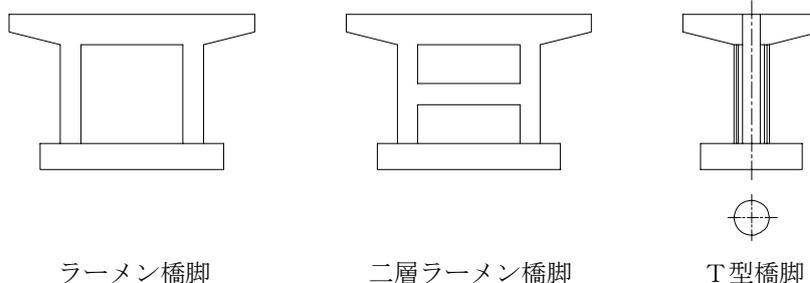
図-3.1 点検対象の鋼製橋脚の例
