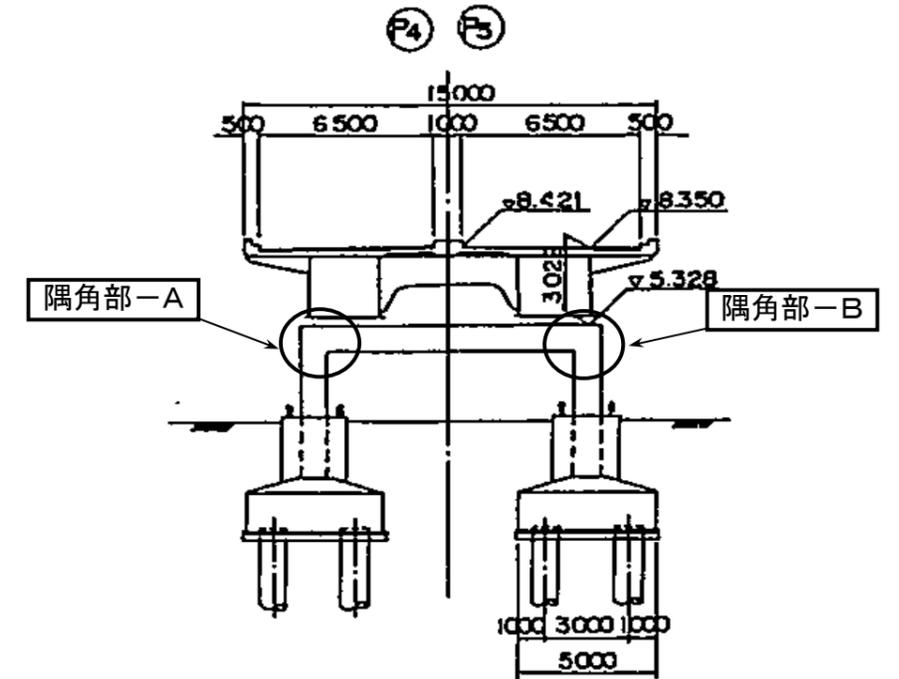
注)隅角部の詳細図が無い場合は、溶接線の位置が分かるように板組み概略図と同様なスケッチをする。
