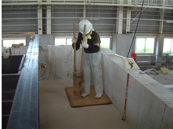
写真-2.4 地盤の締固め方法
