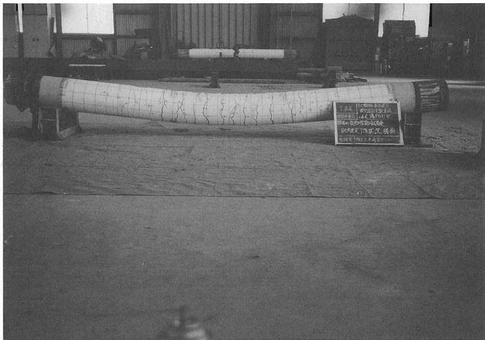
写真-3-4 試験終了時状況（鉄筋コンクリート杭）
