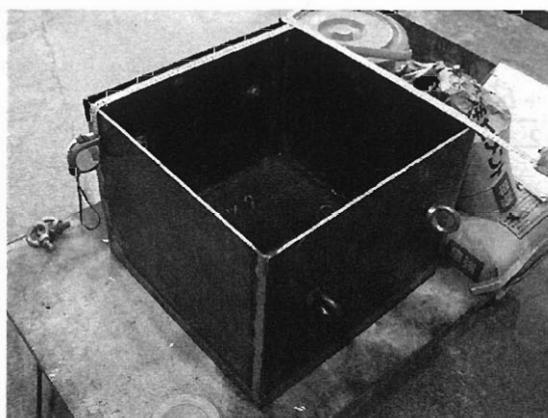
写真-2.3 鉛直載荷実験用模型 (外枠鋼板)
