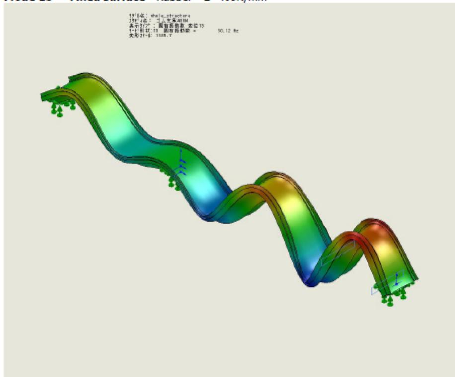
図 4-19 ゴム (E=400N/mm<sup>2</sup>) 支承下部面固定 モード図 (モード 13)
