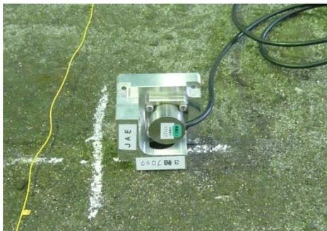
写真 1-1 サーボ型加速度計 JA-40GA
