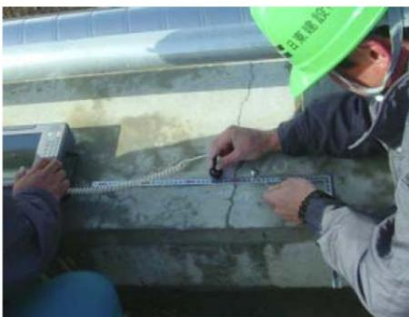
図 4-1 ひび割れ測定状況
