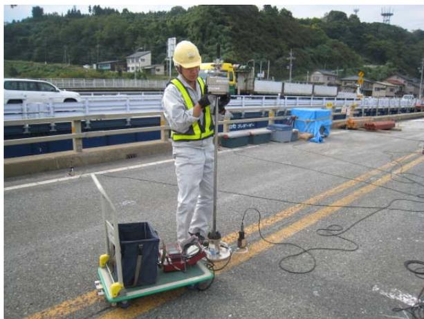
写真 5-1 重錘落下法による加振状況
