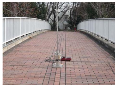
写真 1-5 使用した加振器
