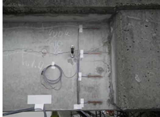
d) G10 桁側面 計測位置 8m
