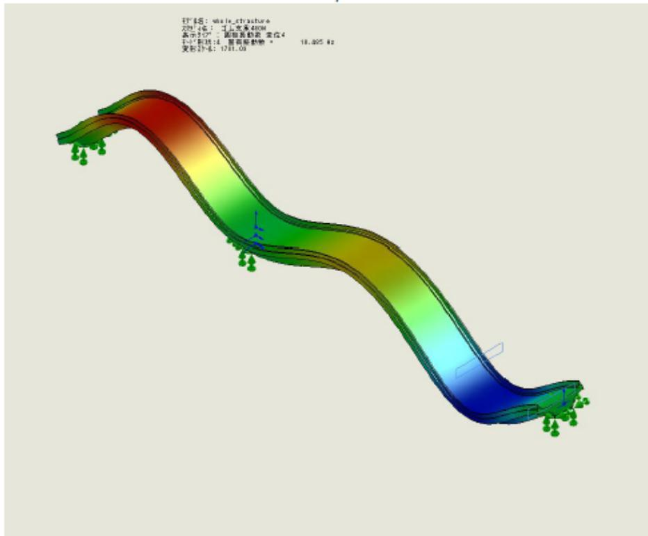
図 4-14 ゴム (E=400N/mm<sup>2</sup>) 支承下部面固定 モード図 (モード 3, 4)
