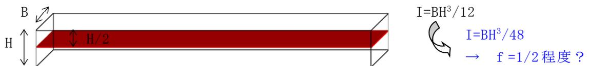
図 5-1 ひび割れが入ったことによる剛性低下の概念図
