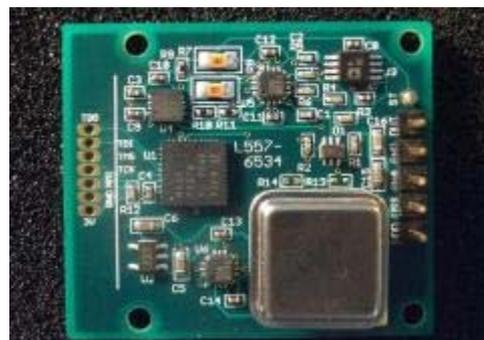
写真 1-2 MEMS 加速度計(開発中)
