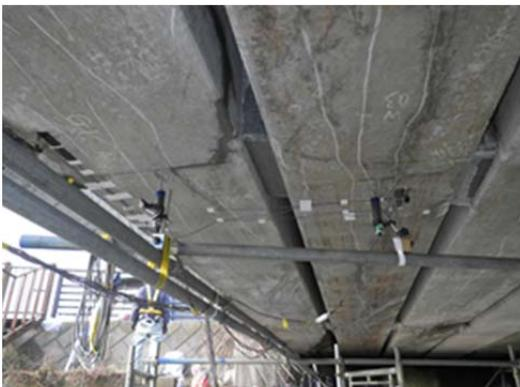
g) G1・G2 桁下面 計測位置 8m
