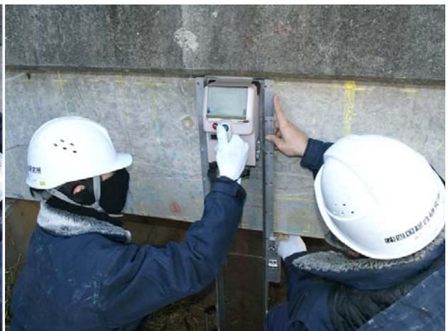
(6) 橋台からの磁気計測ユニットによる磁束密度測定
