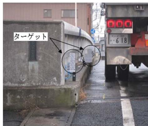
写真 2-5 ターゲット設置状況
