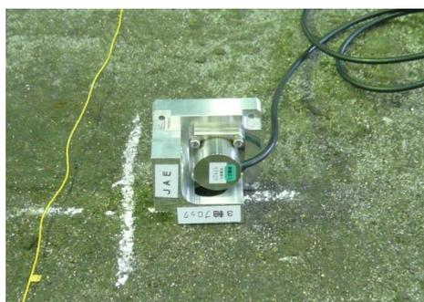
写真 5-2 サーボ型加速度計 JA-40GA
