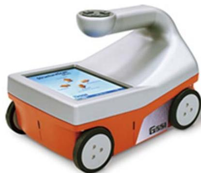
写真 2-2 電磁波レーダ
