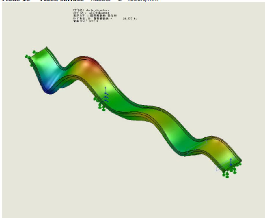
图 4-26 ゴム (E=4000N/mm<sup>2</sup>) 支承下部面固定 モード図 (モード 9, 10)
