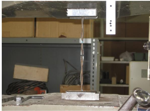
b) 鋼材破断後
