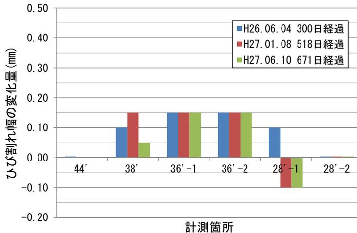
図- 4.8 ひび割れ幅の変化量 (ひび割れゲージ)
