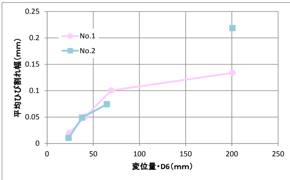
図－ 3-17 変位と平均ひび割れ幅
