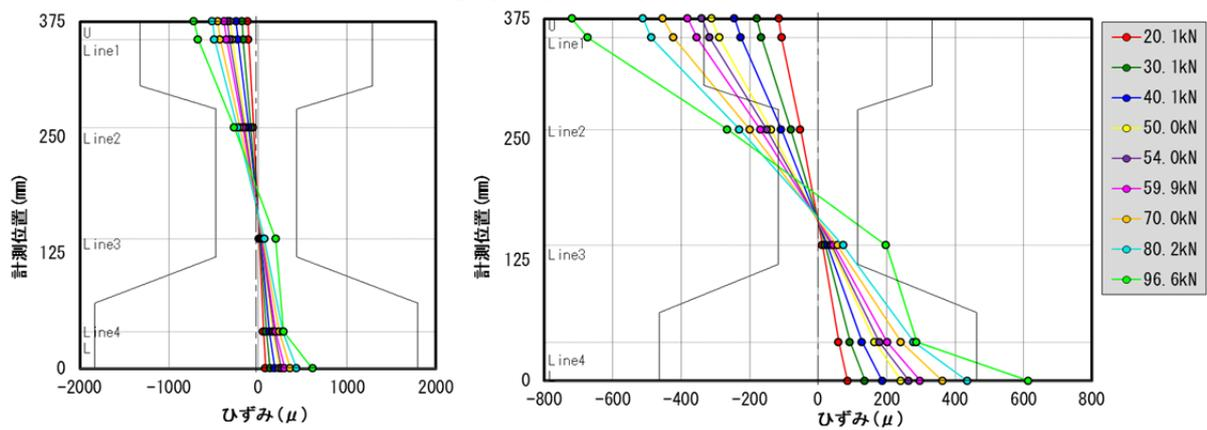
図- 3.52 橋軸方向のひずみ分布 C9 断面 (A・B 面平均)
