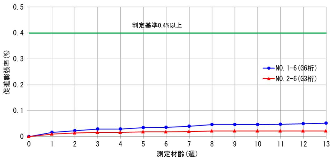
図-5.8 促進養生試験結果 デンマーク法
