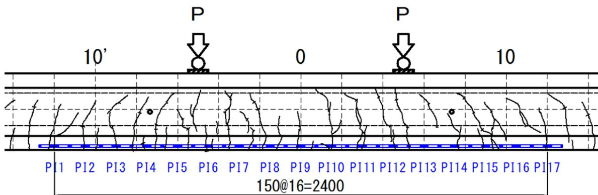
図- 3.33 96.9kN 載荷時 桁側面ひび割れ図
