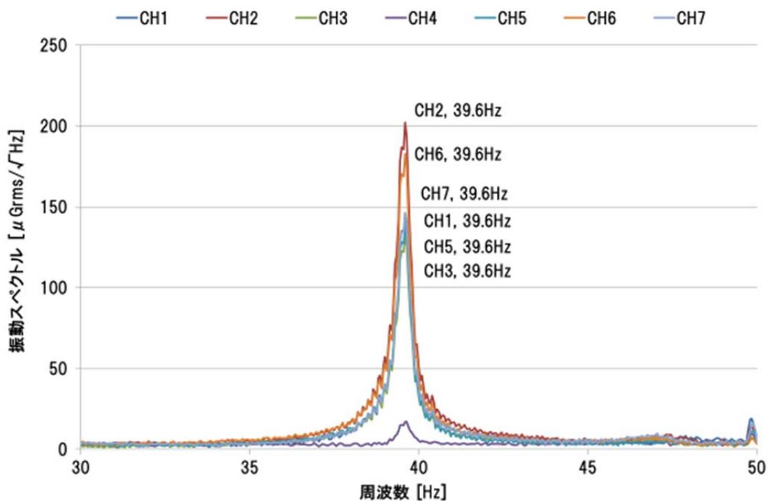
図 8 試験開始前の 2 次モードのスペクトル
