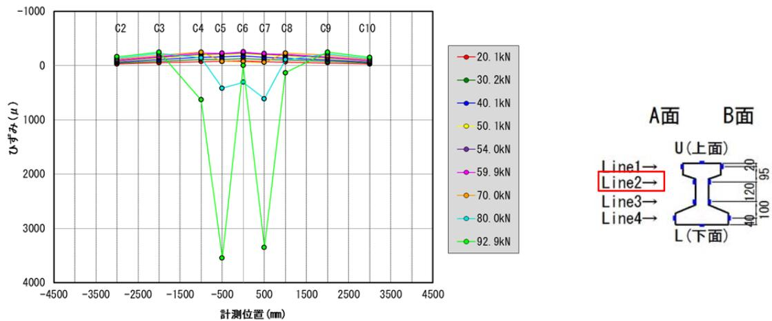
図- 3.16 橋軸方向のひずみ分布 Line-2(A・B面平均)
