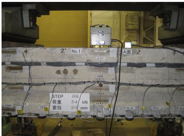
初期ひび割れ発生時 (54kN) 側面
