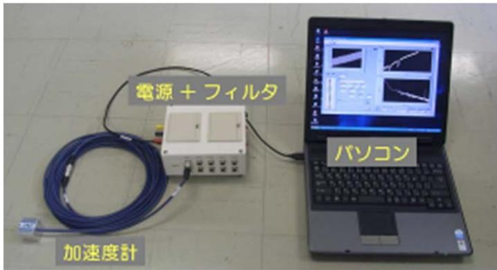
図1 振動計測システム
