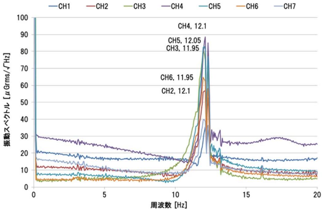
図 28 試験開始前の 1 次モードのスペクトル
