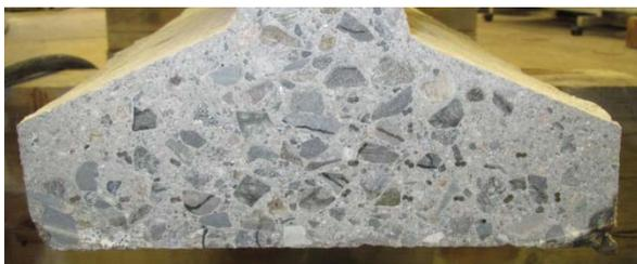
c) G6 桁 22' 桁切断面 (下フランジ)
