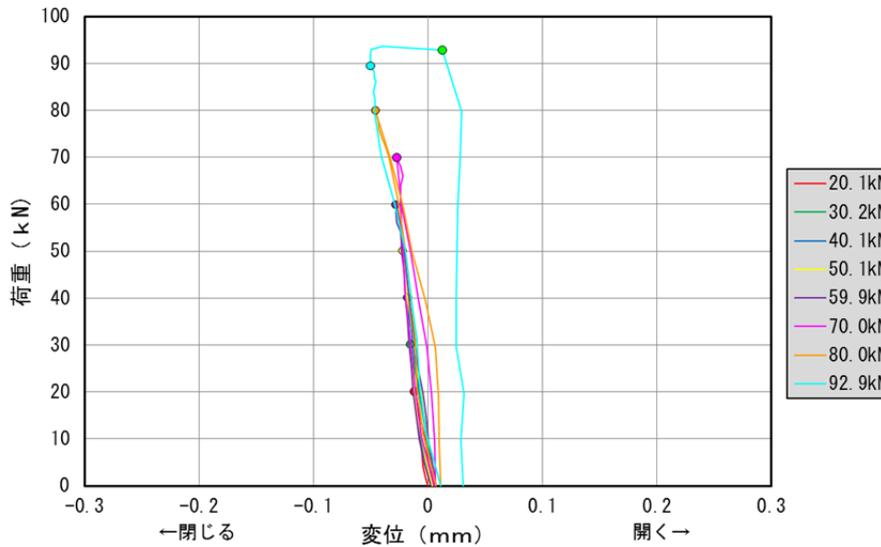
図- 3.10 G6 桁下面の橋軸方向ひび割れ開閉量 (PI-18)
