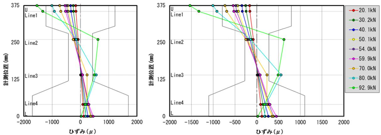
図- 3.22 断面高さ方向のひずみ分布 C4 断面 (A・B 面平均)
