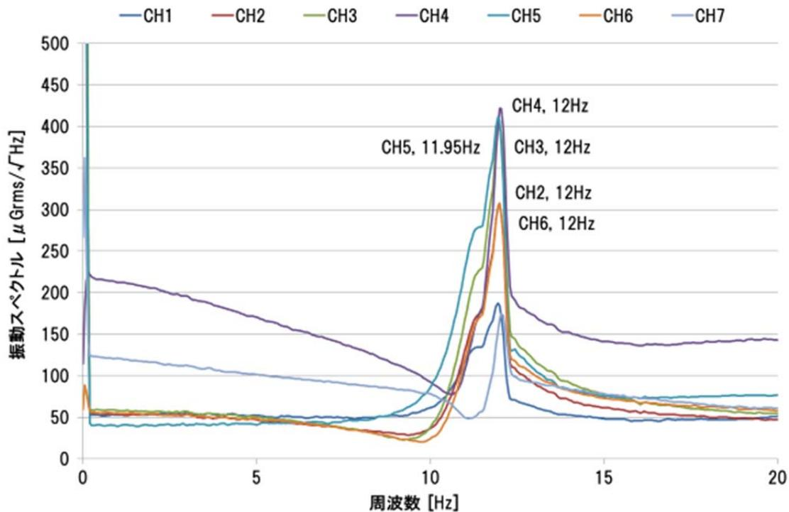
図 7 試験開始前の 1 次モードのスペクトル
