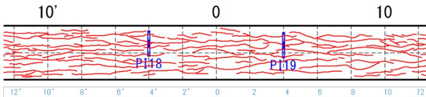
図- 3.34 G3 桁下面橋軸方向ひび割れの計測位置
