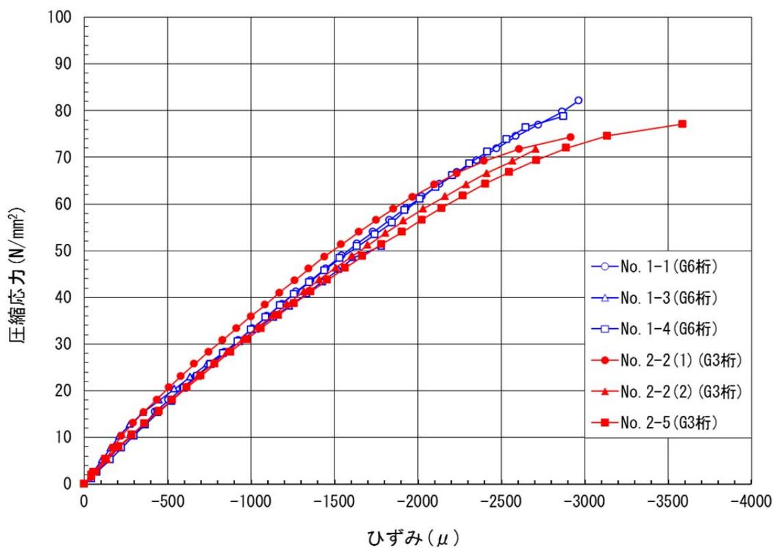
図-5.4 圧縮応力度-ひずみ曲線
