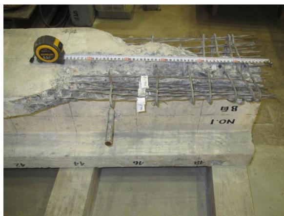
b) PC 鋼材試験片採取
