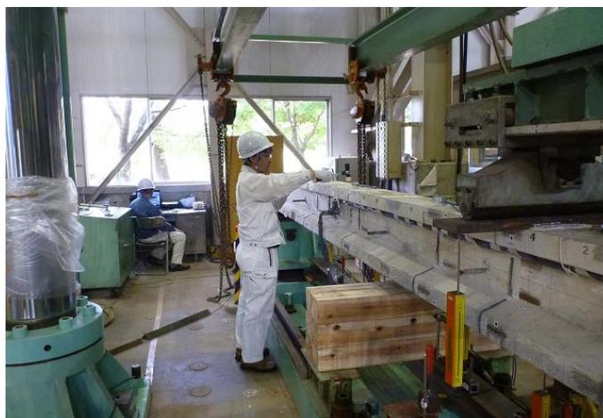
写真 4-3 ハンマーによる加振状況
