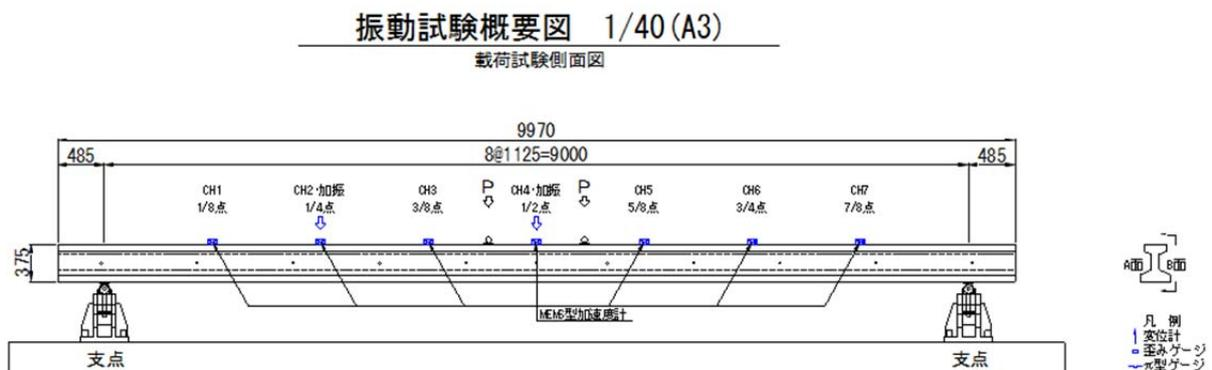
図3 加速度計設置位置
