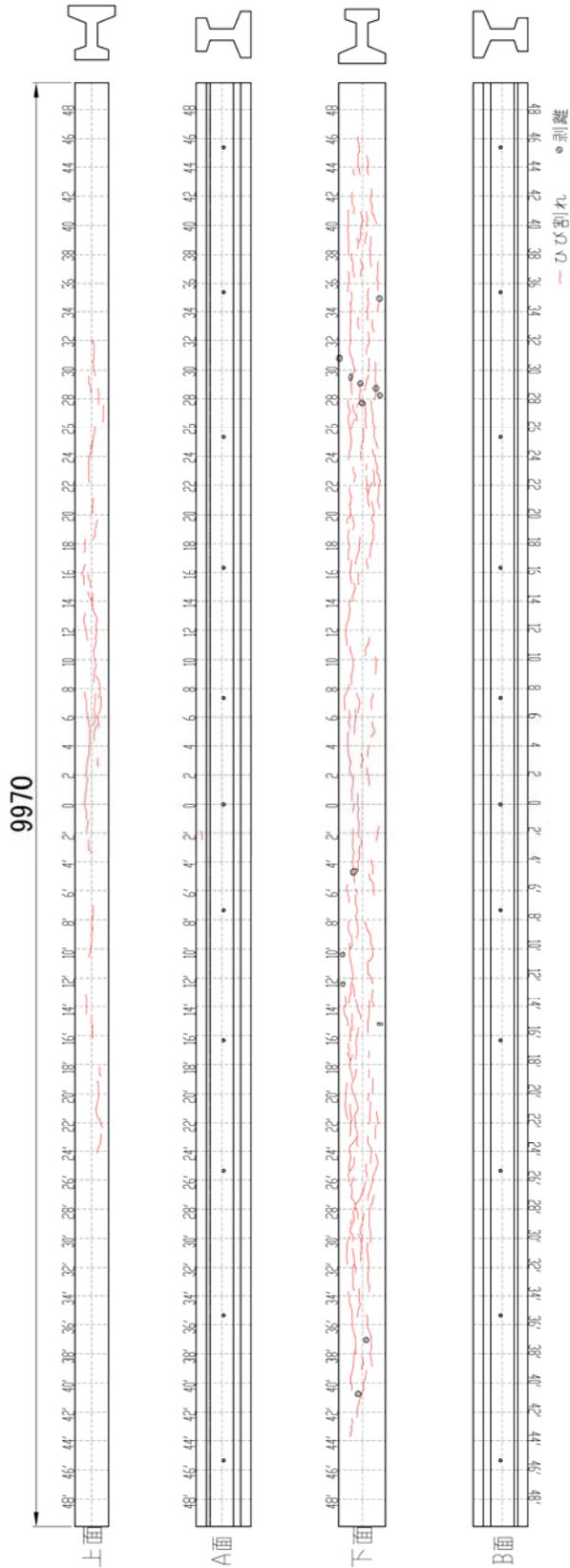
図- 2.4 G6 桁損傷図
