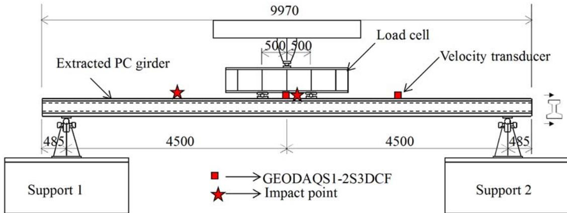
図 2 载荷試験および振動実験の概要図
