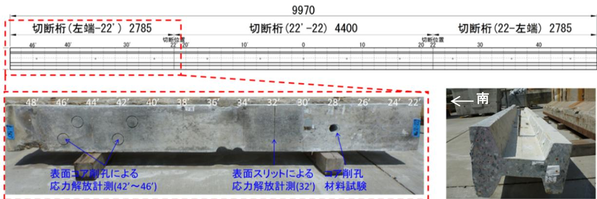
図- 4.7 暴露試験体の設置状況
