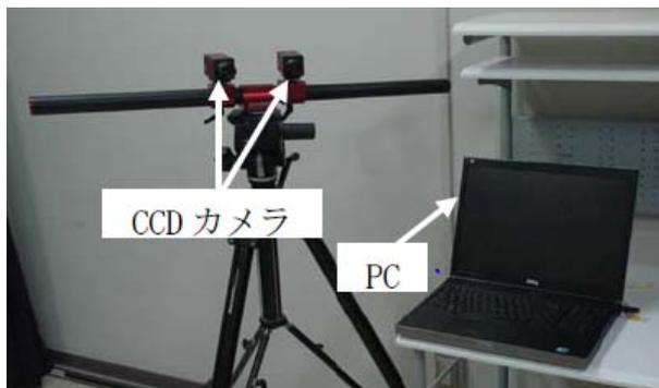
写真 6-1 計測装置
