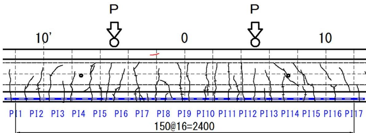
図- 3.8 90kN 載荷時 桁側面ひび割れ図
