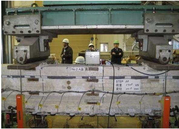
初期ひび割れ発生時 (54kN) 側面
