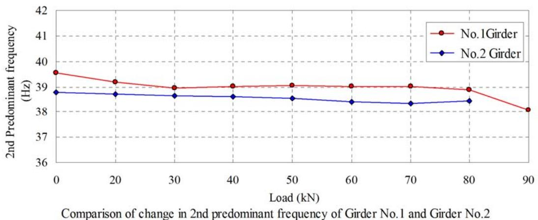
図7 固有振動数の変化（1・2次固有振動数）
