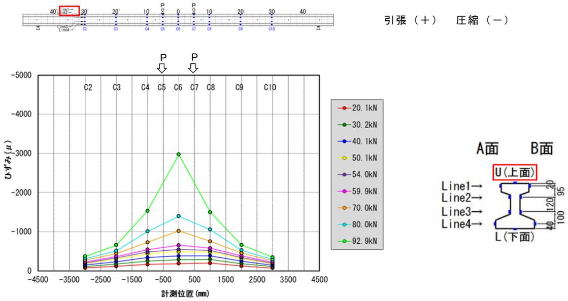
図- 3.14 橋軸方向のひずみ分布 U(上面)
