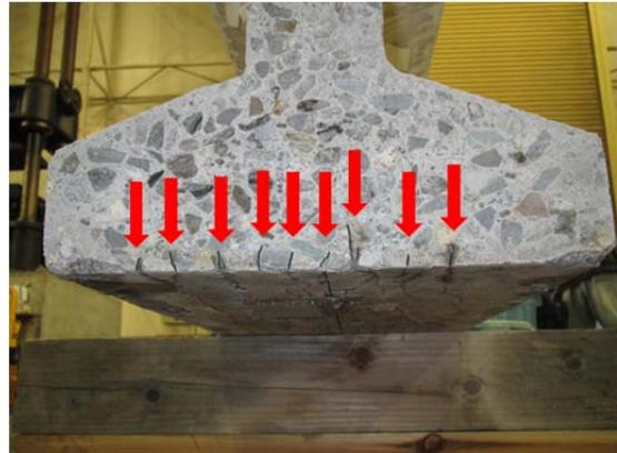
桁下面のひび割れ深さは約 5~15mm で、骨材にそったひび割れの他に一部骨材を貫通するひび割れが認められた。
