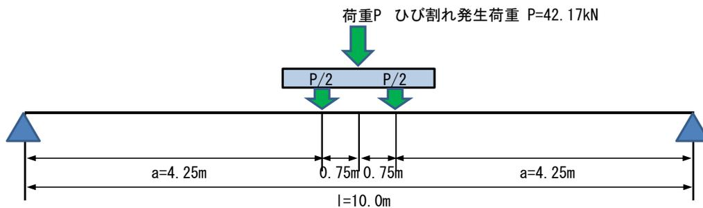
図- 6.5 載荷試験方法（JIS A5319）
