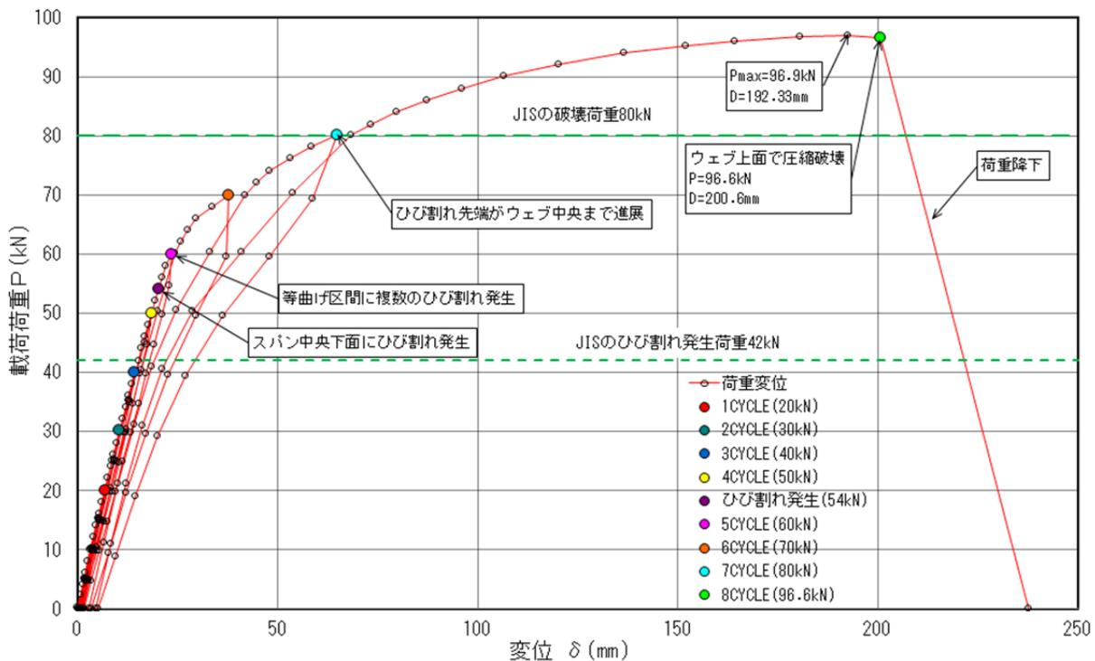
図- 3.29 G3 桁 荷重-変位曲線
