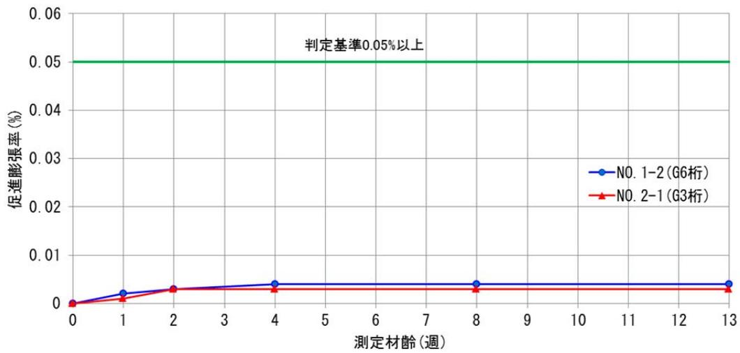
図-5.6 促進養生試験結果 JCI-DD2 法
