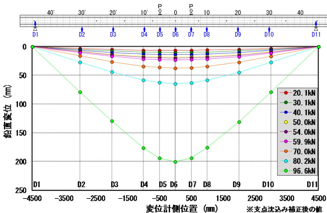
図- 3.31 G3桁 橋軸方向のたわみ分布
