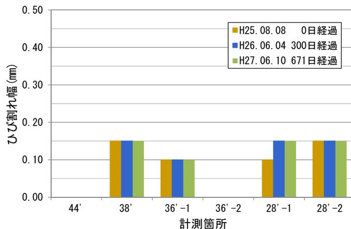
図- 4.9 ひび割れ幅 (クラックスケール)
