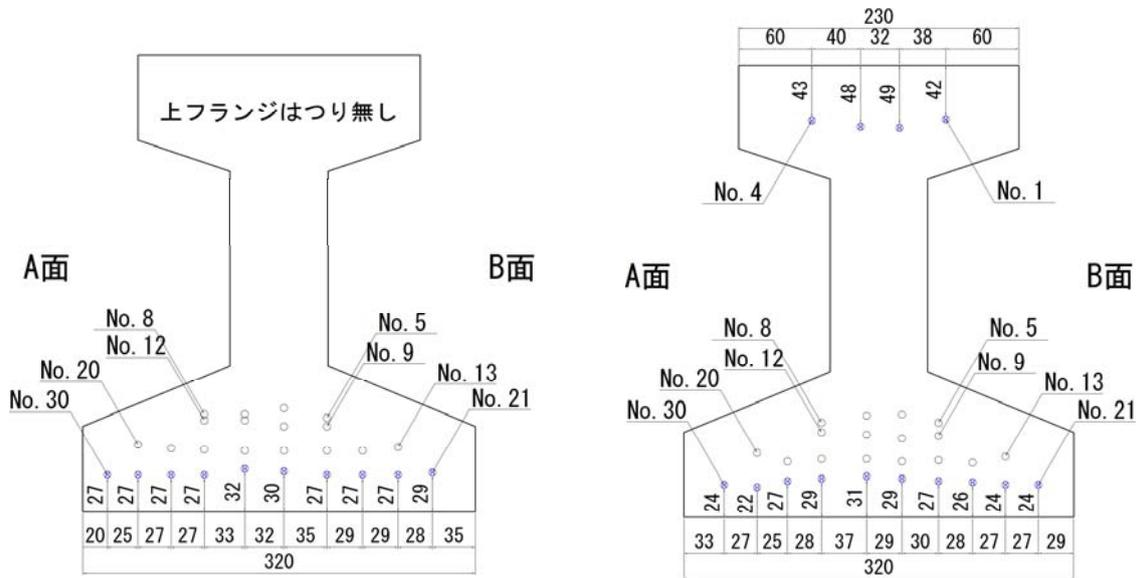
図- 4.3 G6 桁 PC 鋼材純かぶり (5 断面付近) 図- 4.4 G3 桁 PC 鋼材純かぶり (5 断面付近)
