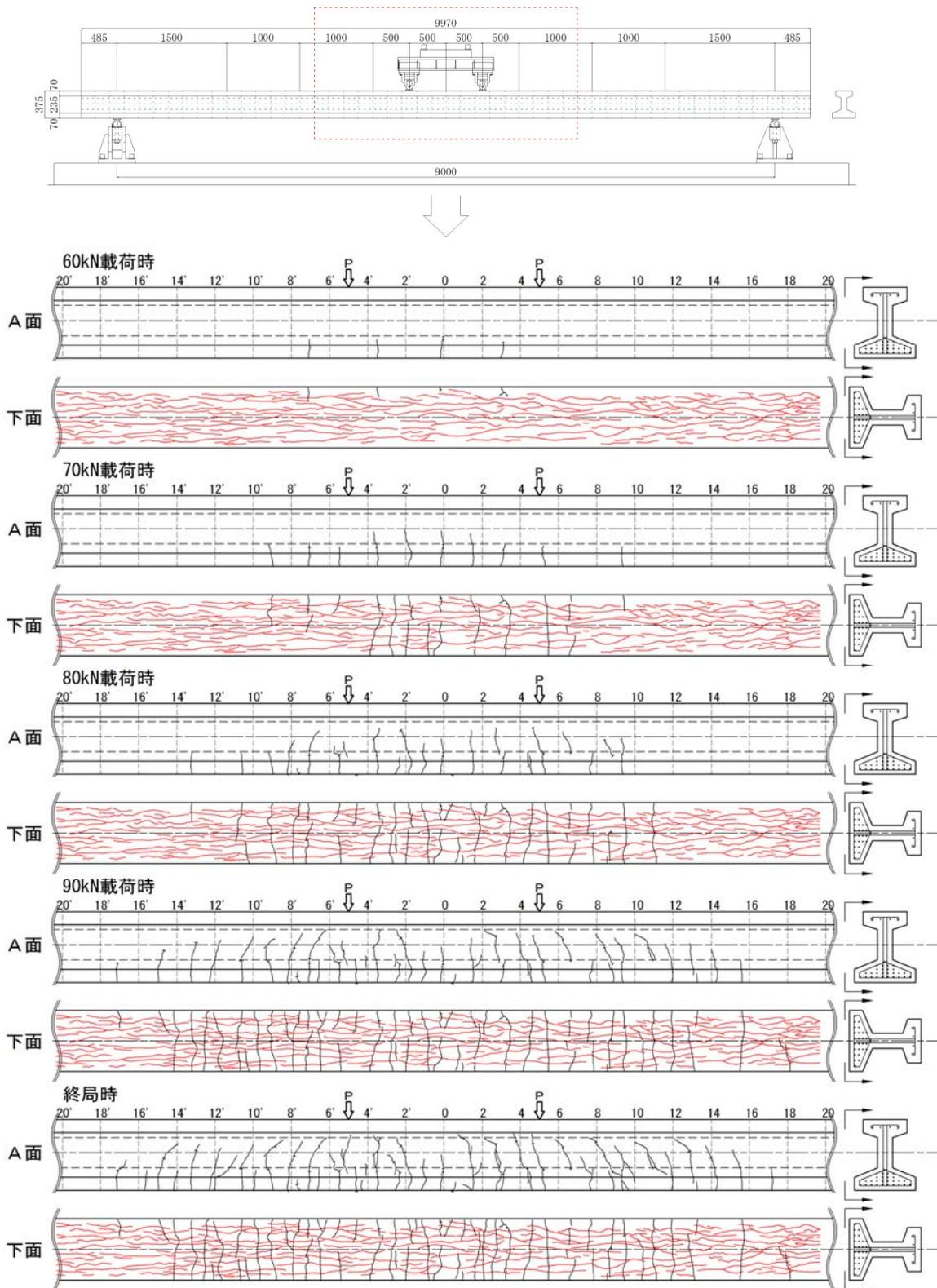
図- 3.30 G3 桁 ひび割れ進展図 (赤線 : 載荷前の橋軸方向ひび割れ)
