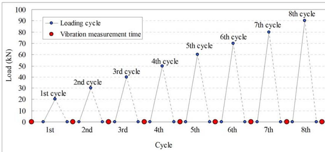
図 3 繰り返し载荷サイクルと振動測定のプロット時刻歴
