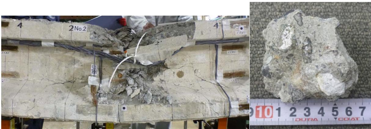
写真-5.3 コンクリート片 (G3 桁)
