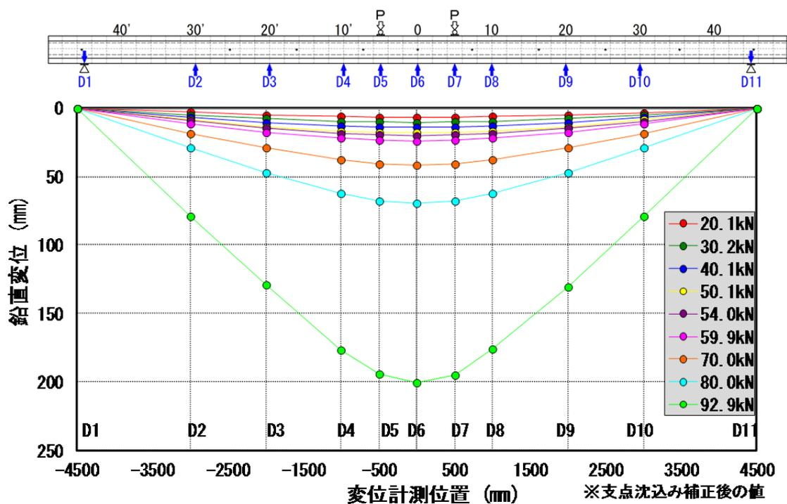
図- 3. 6 G6 桁 橋軸方向のたわみ分布
