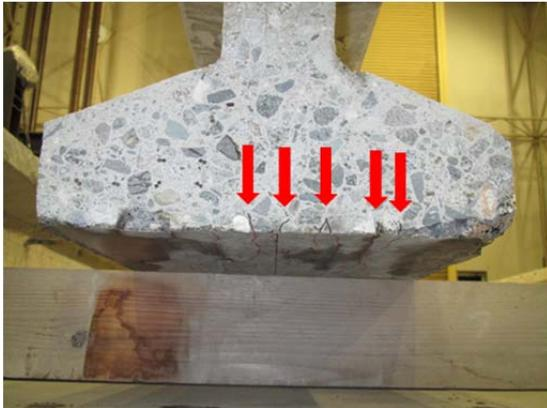
桁下面のひび割れ深さは約 6~11mm で、骨材にそったひび割れの他に一部骨材を貫通するひび割れが認められた。
