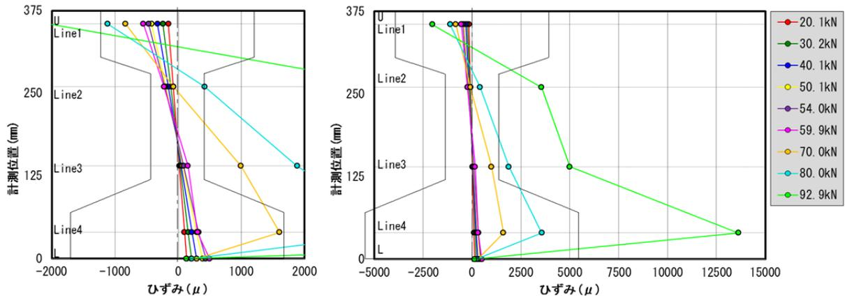
図- 3.23 断面高さ方向のひずみ分布 C5 断面 (A・B 面平均)
