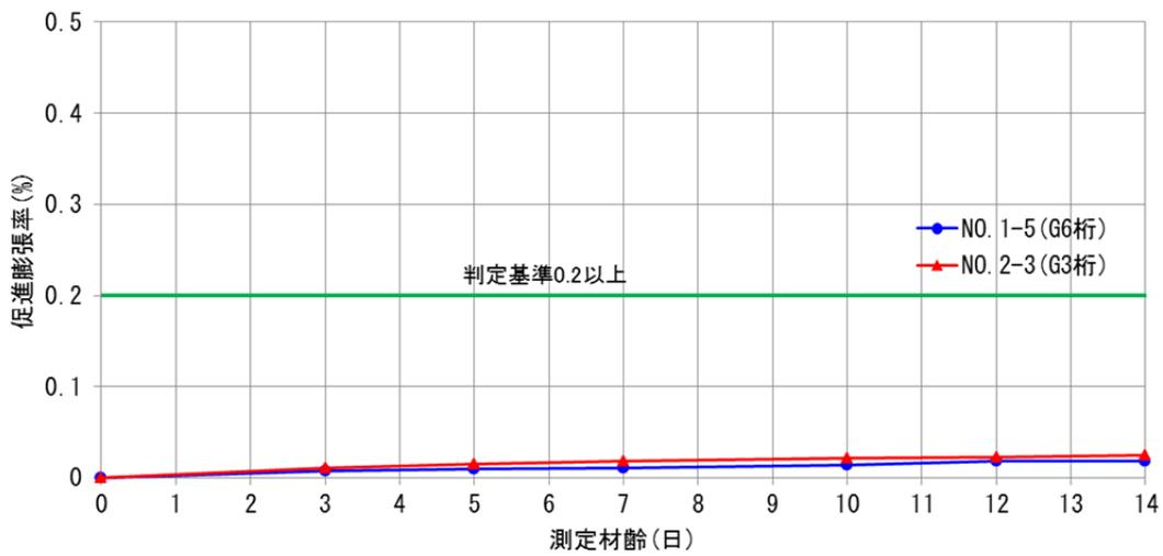
図-5.7 促進養生試験結果 カナダ法
