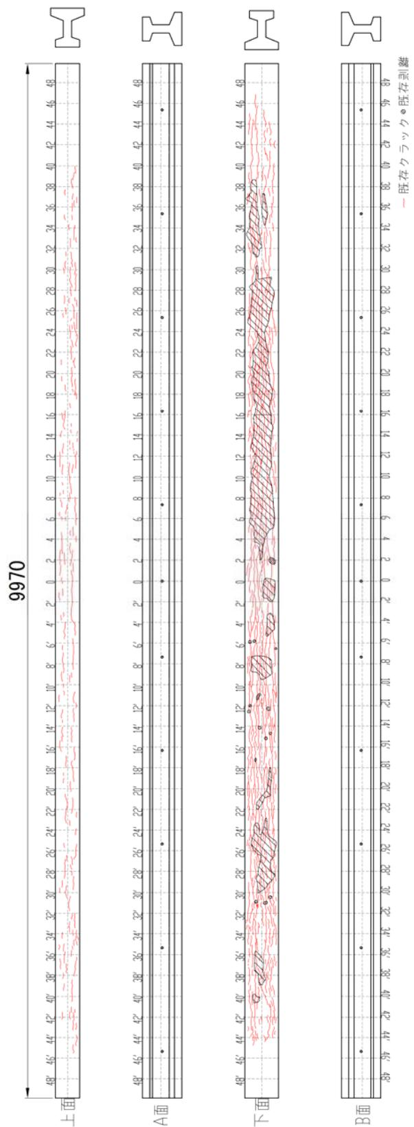
図- 2.5 G3 桁損傷図
