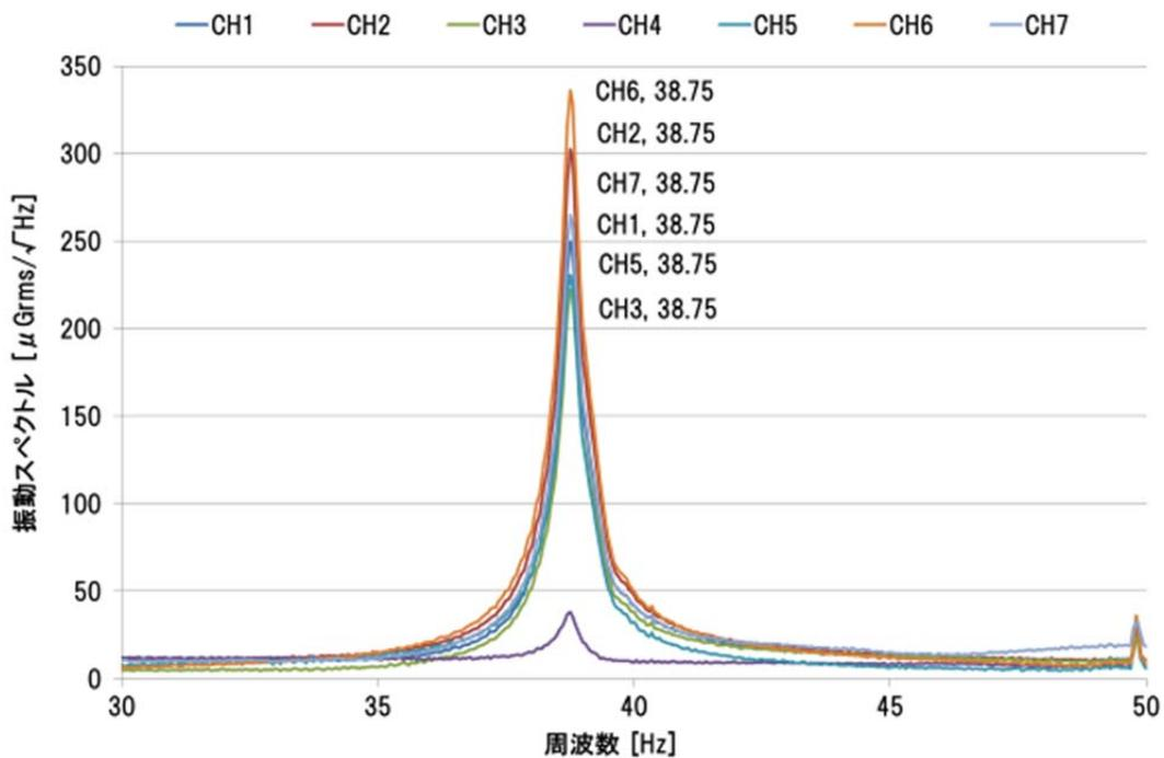
図 29 試験開始前の 2 次モードのスペクトル
