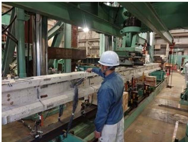
写真 4-1 プラスチックハンマーによる加振状況
