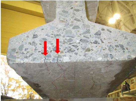
桁下面のひび割れ深さは約 6~7mm で、骨材を貫通するひび割れが認められた。
