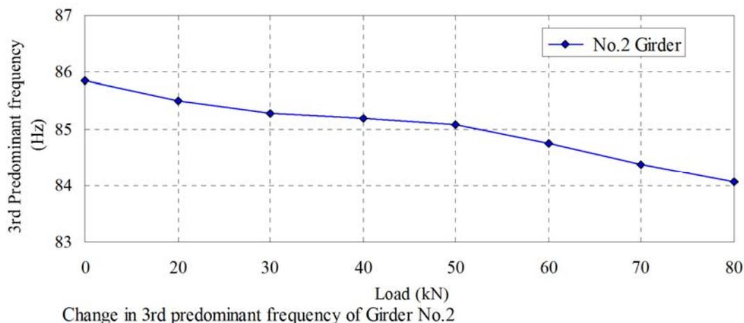
図 8 固有振動数の変化（3 次固有振動数）
