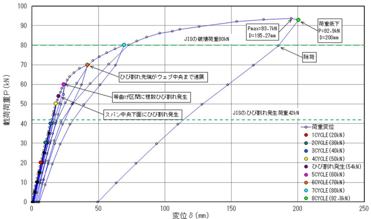
図- 3.4 G6 桁 荷重-変位曲線
