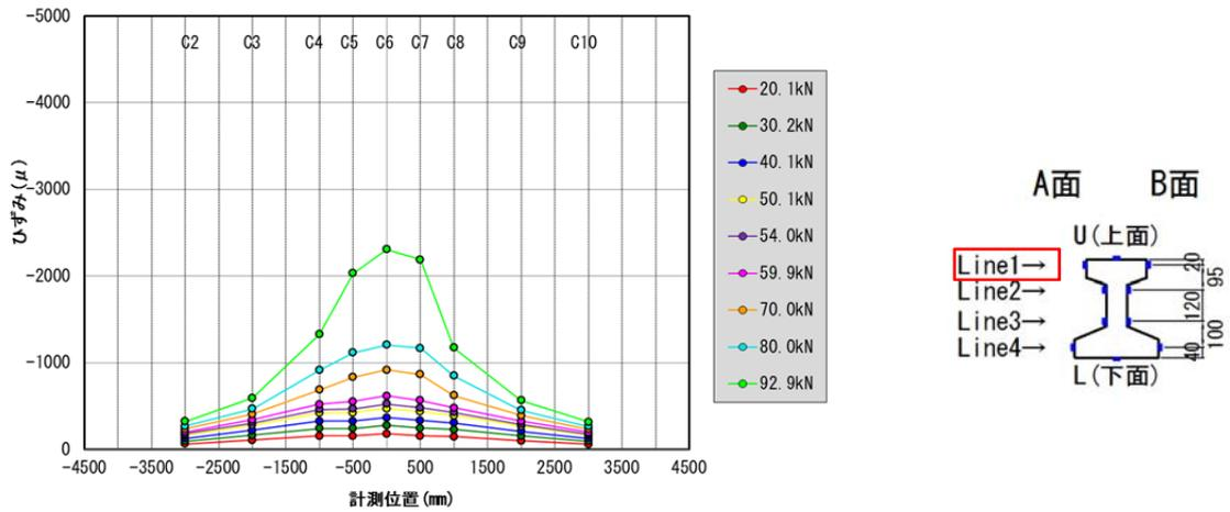
図- 3.15 橋軸方向のひずみ分布 Line-1(A・B面平均)
