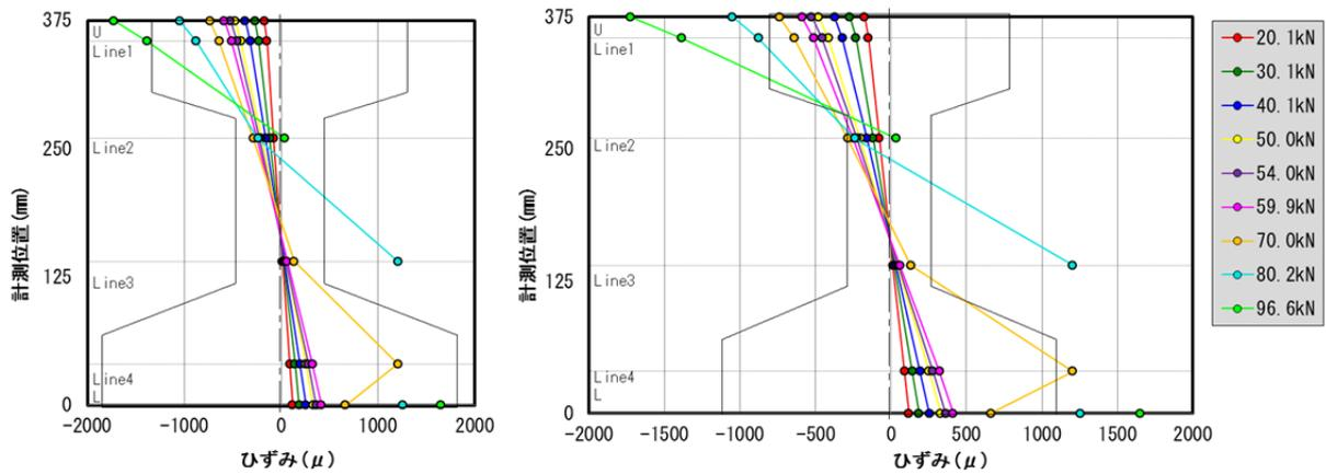
図- 3.47 橋軸方向のひずみ分布 C4 断面 (A・B 面平均)
