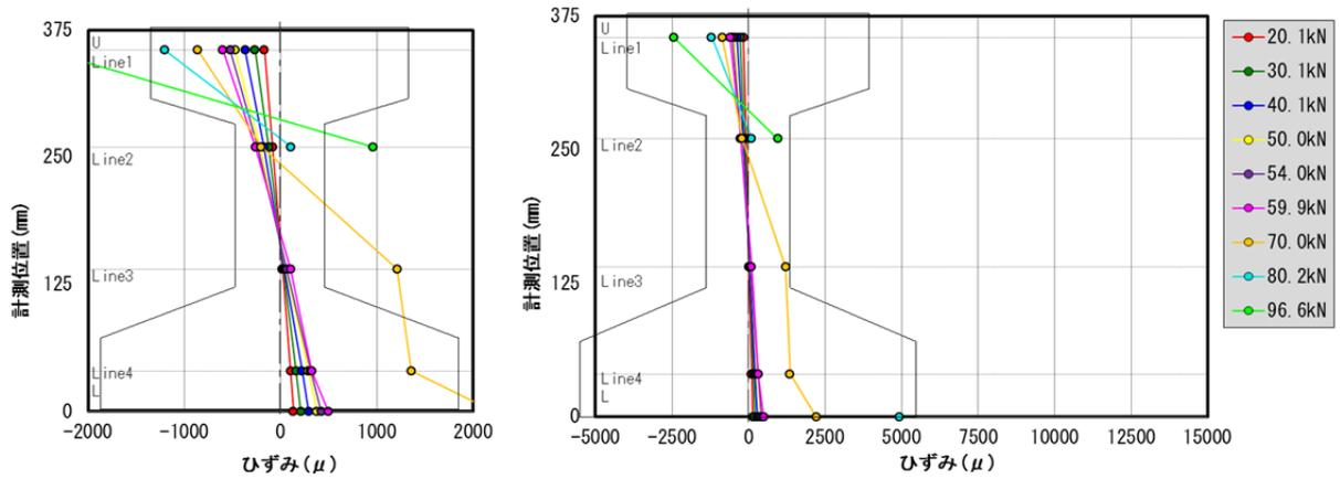
図- 3.48 橋軸方向のひずみ分布 C5 断面 (A・B 面平均)
