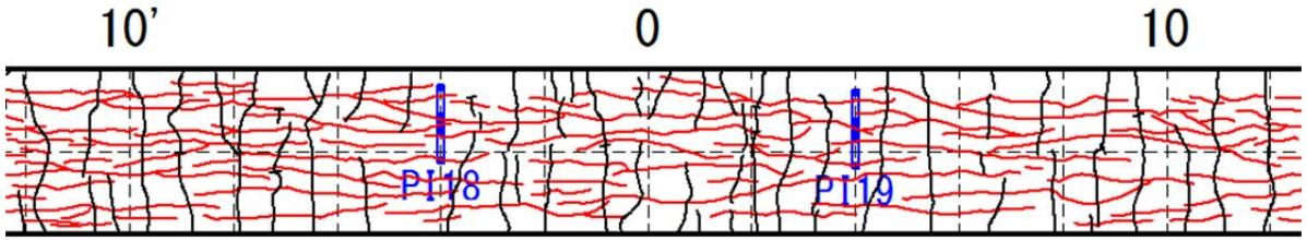
(赤線： 載荷前の橋軸方向ひび割れ 黒線： 載荷によるひび割れ)
