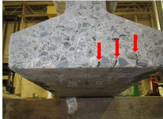
桁下面のひび割れ深さは約 10~19mm で、骨材にそったひび割れが認められた。
