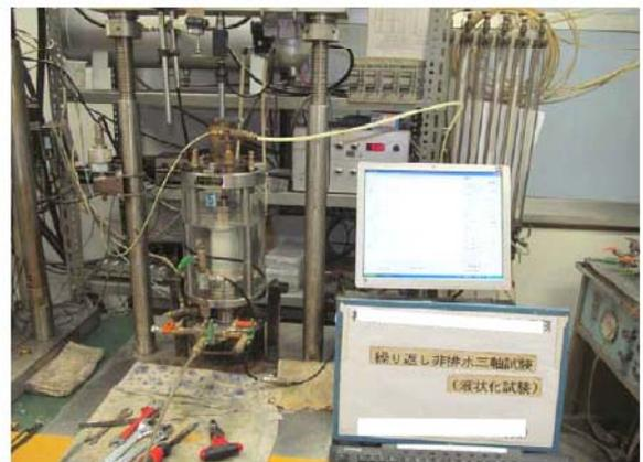
写真-3.3.3 繰返し三軸試験(液状化試験)
