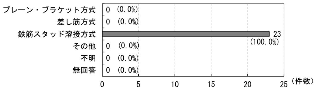
図 3-8.70 頂版と鋼管矢板の結合方法
