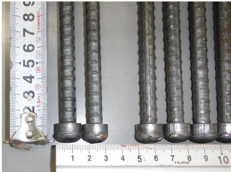
写真-4.3.2 せん断補強 定着体加工部 (図-4.3.4 の A 部)
