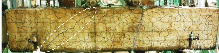
写真-4.4.1 せん断破壊時のひび割れ状況
