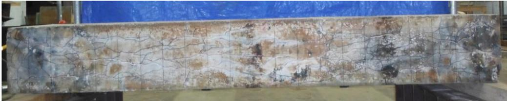
(Case4、ひび割れに着色、側面写真の赤色点線は元の形状)
