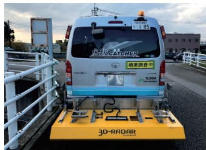
写真-5 車載式電磁波レーダ
