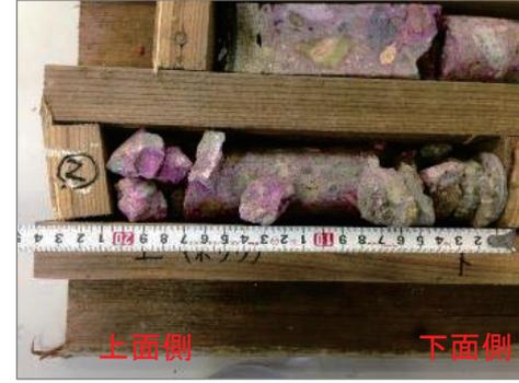
写真-4. 床版コンクリートコア採取は劣化のためコア形状として採取できず
