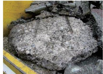
写真-3. 舗装と一緒にコンクリートが剥がれた舗装裏面
