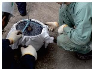
写真-6 温度・流動性測定状況
