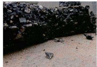
写真-3. アスファルト劣化断面(骨材剥離)
