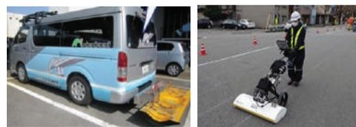
電磁波レーダー(車載式・手押しカート式)
