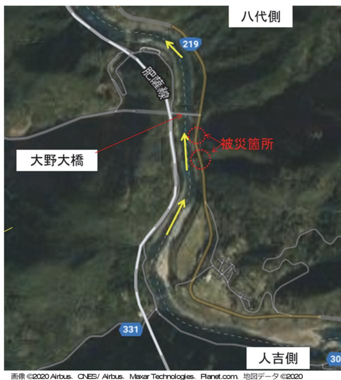
写真-4.1.9 大野大橋付近の国道219号 被災箇所位置図<sup>2)</sup>に被災箇所等の情報を加筆
