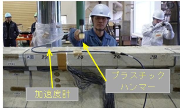
写真 4.1.2 ハンマによる加振状況
