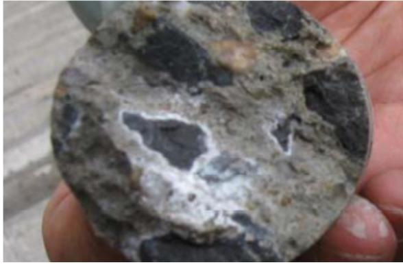
写真 6.2.6 採取コアの破断面
