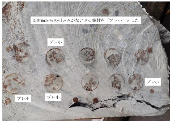
写真 6.3.3 G4 桁支間中央付近の撤去桁のひび割れ状況 (左) と切断面の状況 (右)
