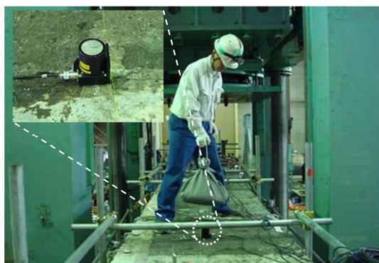
写真 4.2.1 砂袋による加振状況
