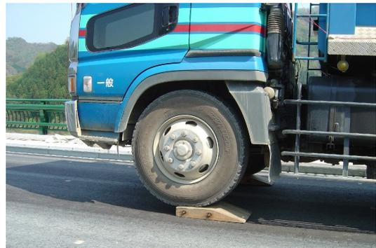
写真 2.2.1 衝撃加振状況
