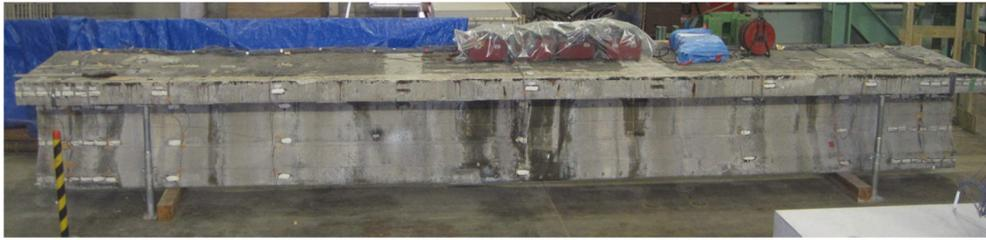
写真 4.1.4 ポストテンション桁載荷前の状況
