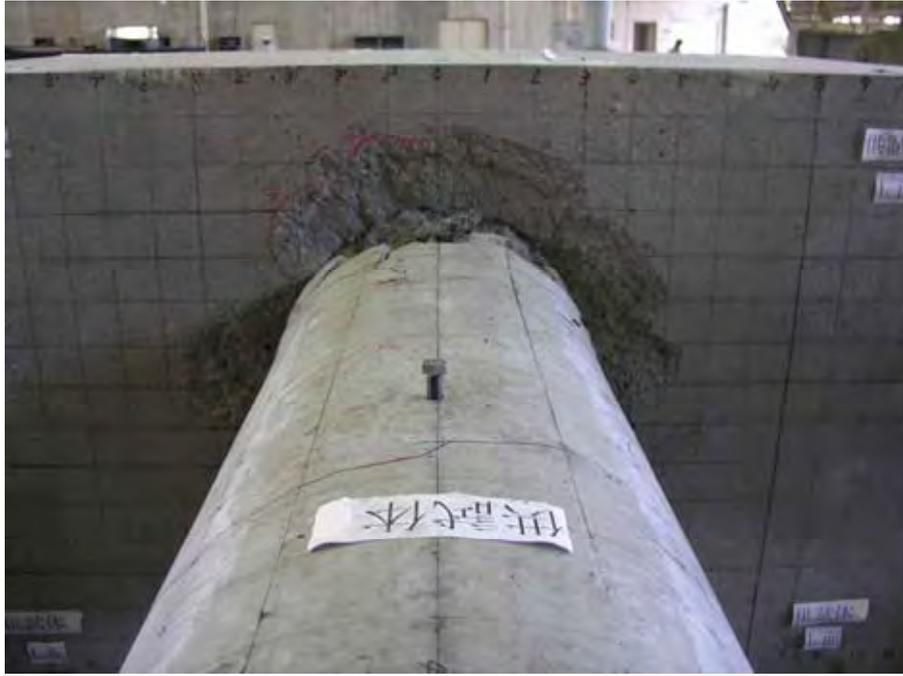
写真-2.2 実験終了後フーチング損傷状況 (Case CPP-S-1)
