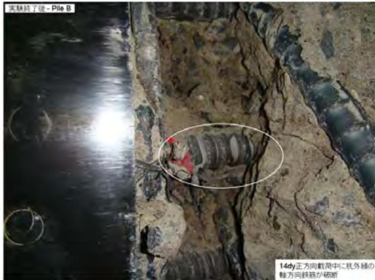
写真-4.22 実験終了後 杭体損傷状況 (Case SPP-C-2, PileB)
