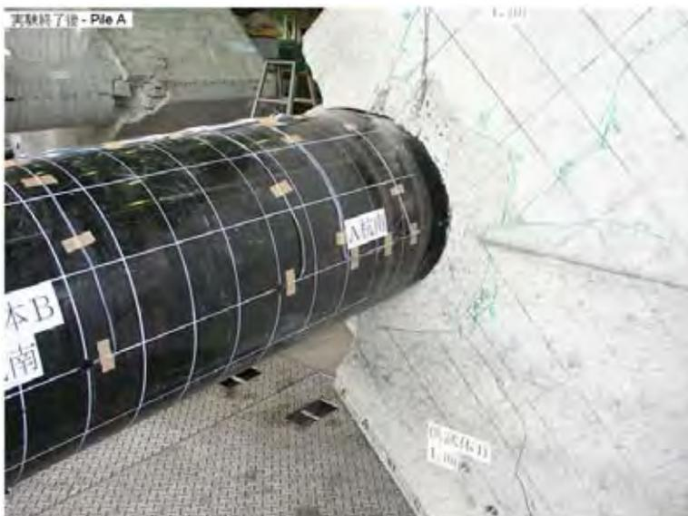
写真-4.16 実験終了後 フーチング下面損傷状況 (Case SPP-C-1, Pile A)
