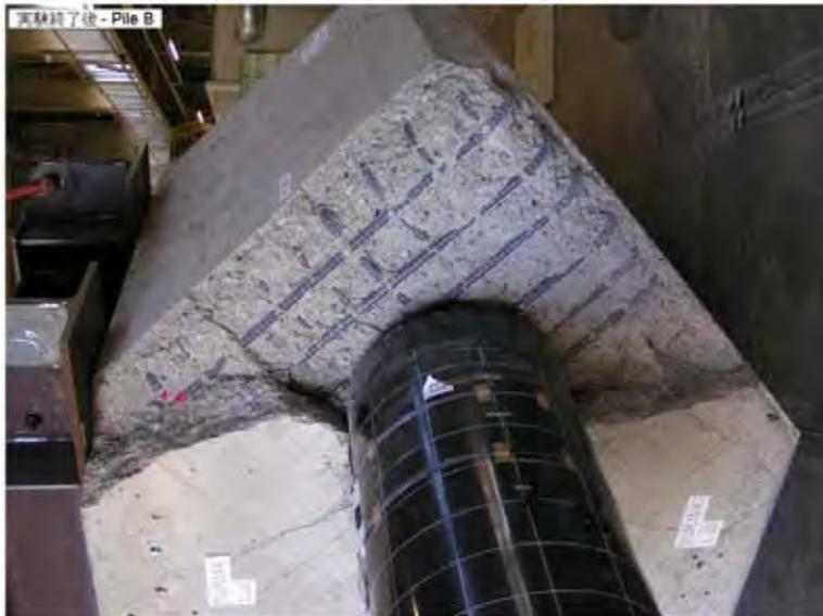
写真-4.20 実験終了後 縁端部損傷状況 (Case SPP-C-2, PileB)
