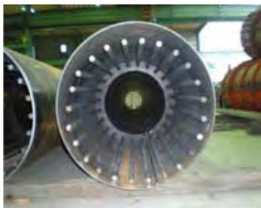
a) 杭体内鉄筋挿入 (杭製造時)
