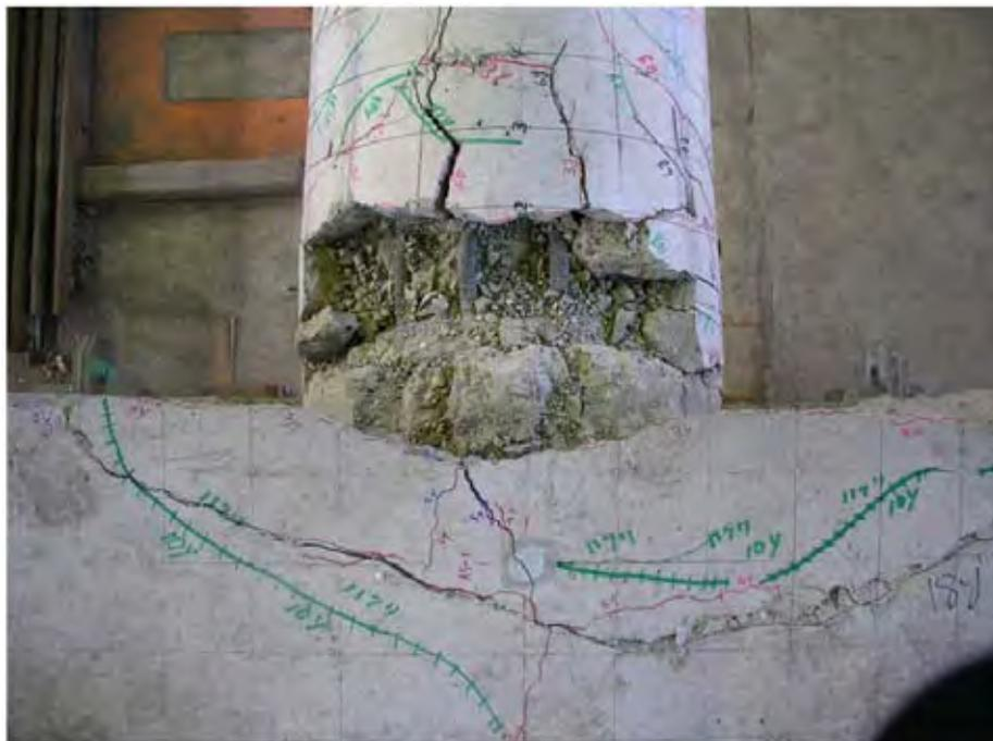
写真-2.7 実験終了後杭体損傷状況 (Case CPP-S-3)
