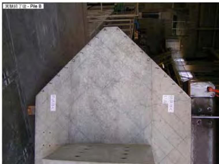
写真-4.24 実験終了後 フーチング上面損傷状況 (Case SPP-C-2, PileB)
