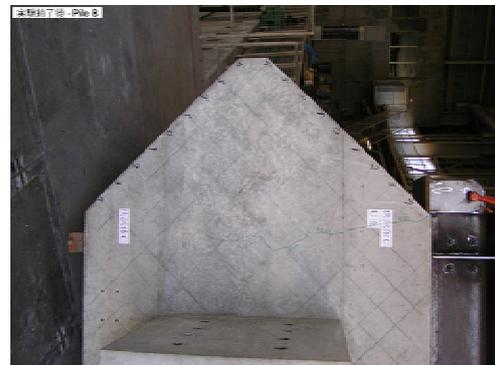
フーチング上面の損傷状況
