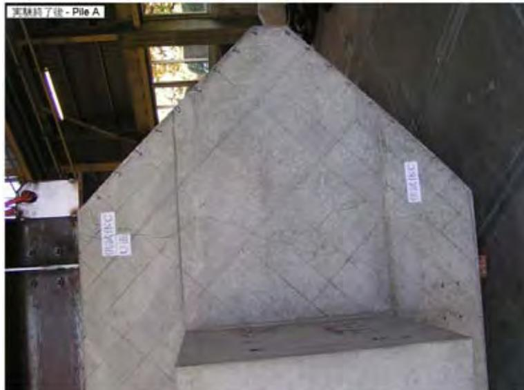
写真-4.23 実験終了後 フーチング上面損傷状況 (Case SPP-C-2, PileA)
