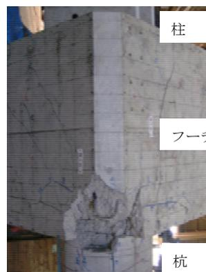
フーチング縁端部の最終損傷状況
