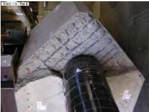
縁端部の損傷状況
