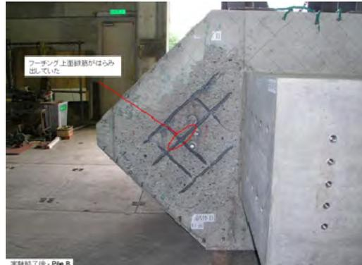
フーチング上面の損傷状況
