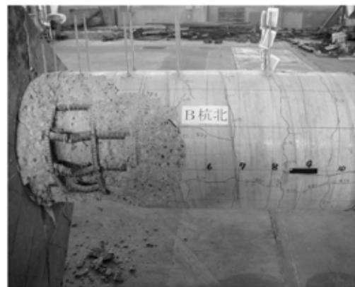
杭の軸方向鉄筋破断
