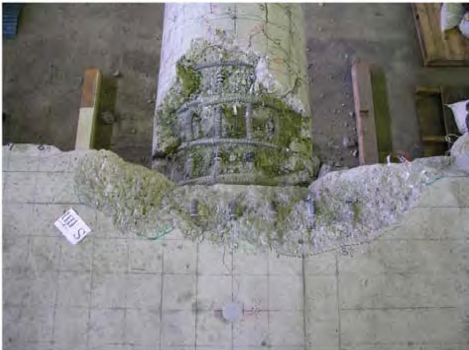
写真-2.5 実験終了後杭体損傷状況 (Case CPP-S-2)
