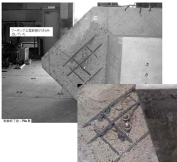
杭の鉛直押抜きせん断破壊
