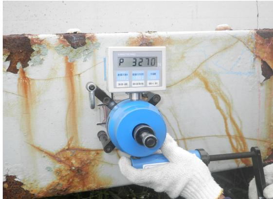
写真 5.3.4 付着試験の実施状況
