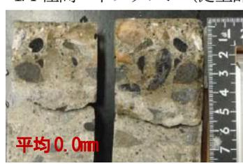
写真 4.3.4 含浸深さの測定状況（現地測定）
