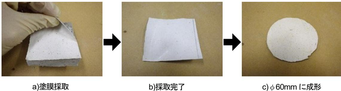
写真 3.3.2 試料（遮塩性試験）の作成方法
