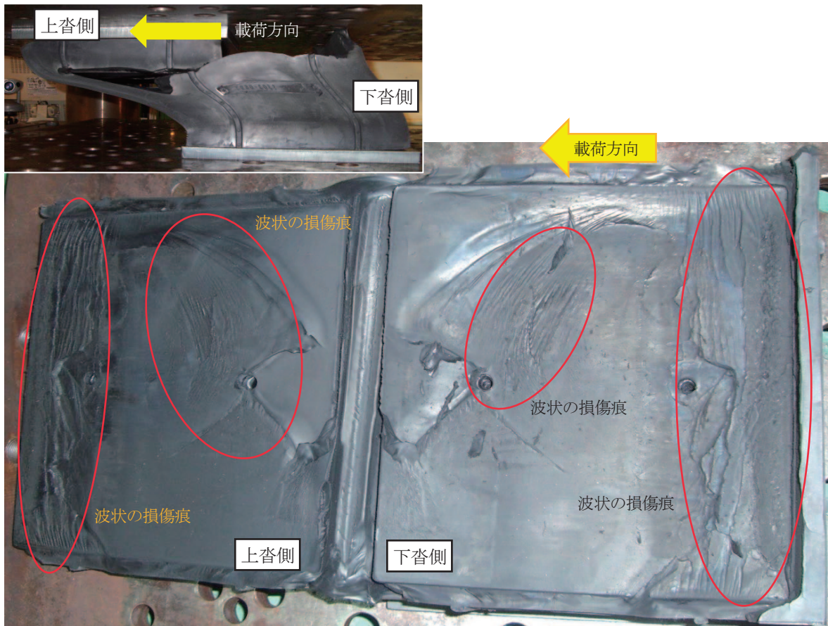
写真-2.4.47 支承载荷実験におけるゴム支承本体の破断面の状態 (写真提供：(株)ビービーエム)
