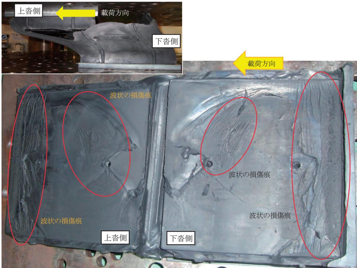
写真-2.4.47 支承载荷実験におけるゴム支承本体の破断面の状態
