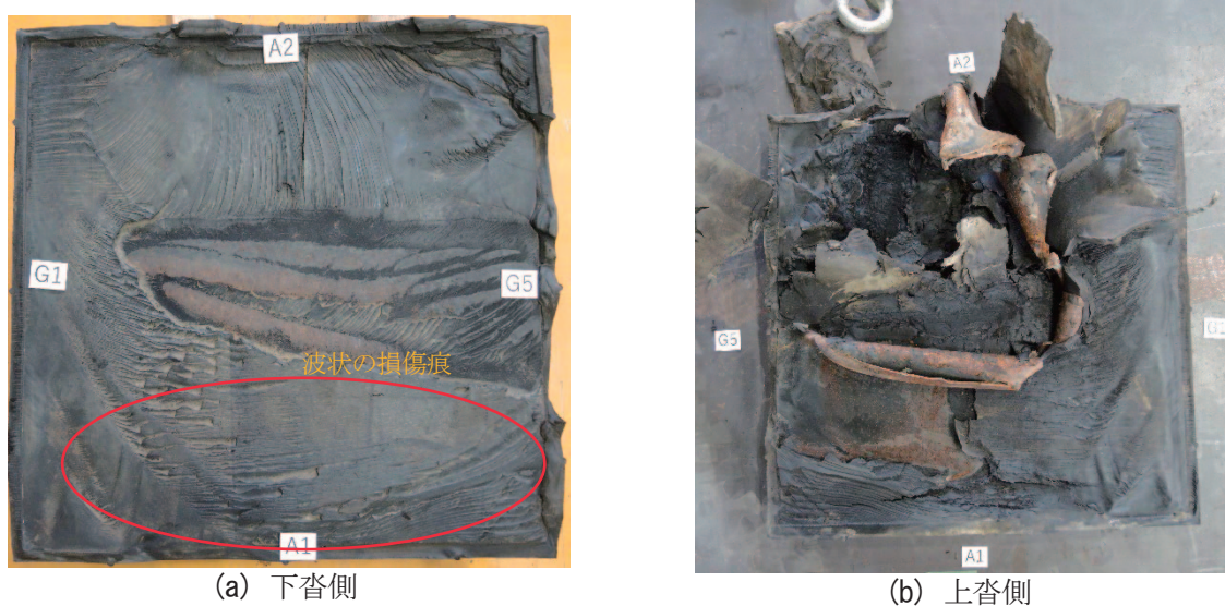
(a) A1 側 (b) G1 側 (c) A2 側 (d) G5 側 補足：ゴム支承本体は完全に破断しているが、写真はゴム支承本体の上に上沓を載せた状態で撮影している 写真-2.4.48 撤去したゴム支承側面の損傷状態(A1G5)
