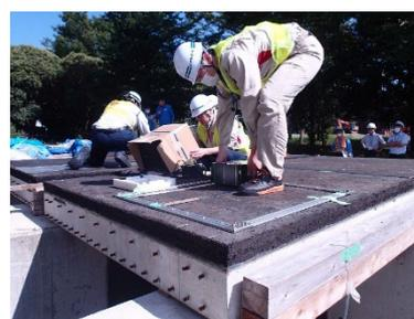
写真 1-3-5 超音波探査
