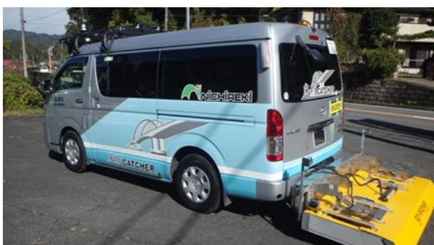
写真 1-3-6 車載式電磁波レーダ
