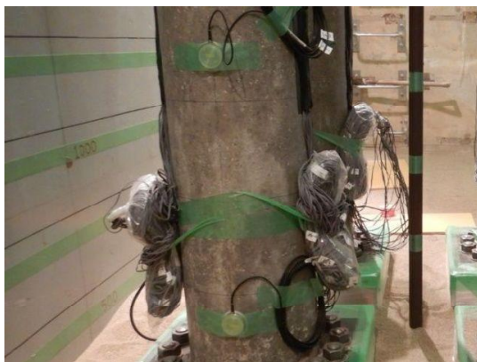
付写真-4.2.171 杭供試体への土圧計設置
