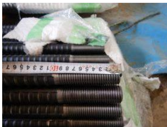
付写真-4.2.3 K 1 SD345 D32 の両端ねじ加工
