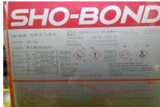
付写真-4. 2. 113 アンカーボルトに用いたエポキシ樹脂 WB グラウト (株)ショーボンドマテリアル
