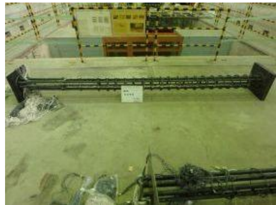
付写真-4.2.46 配筋検査 鉄筋かご 2体目
