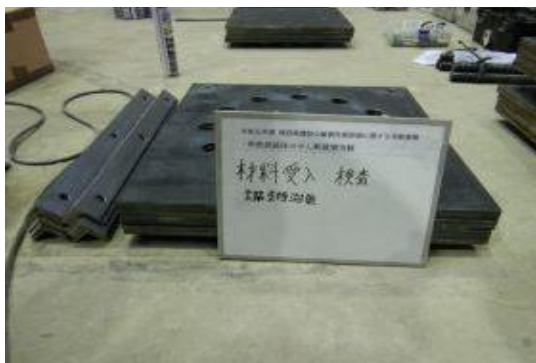
付写真-2.2.11 ④主鉄筋支持治具 製作：8組
