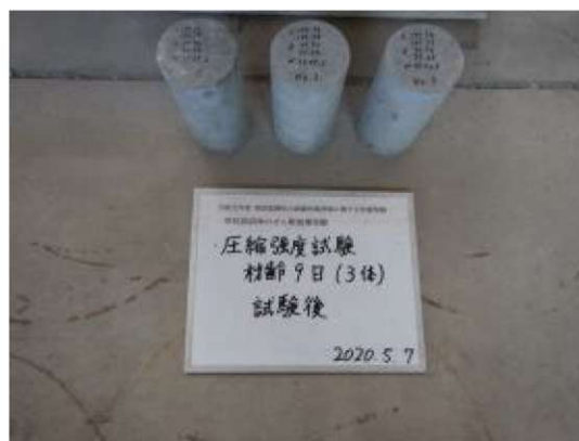
付写真-2.2.67 圧縮強度試験 ( \sigma_{28} )
