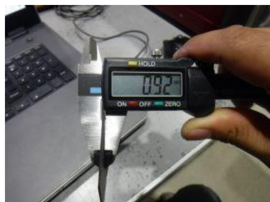
付写真-3.2.19 ゴム板の厚さ測定
