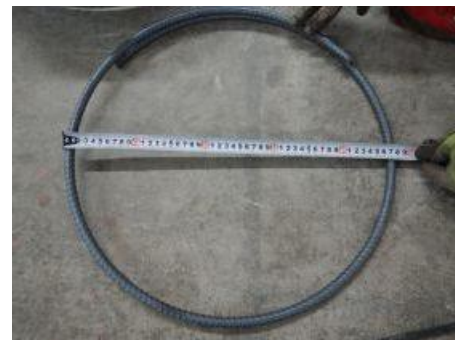
付写真-3.1.4 引張試験片 SD345 D25×L600mm 3本
