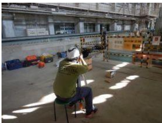
付写真-4. 2. 120 オートレベルにて水平高さ調整
