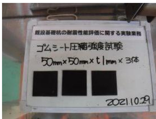
付写真-3.2.18 ゴム板圧縮試験前
