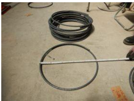
付写真-2.2.5 case5 用帯鉄筋 SD295AD13 重ね継手長 30\phi + 1\phi フックなし 12本
