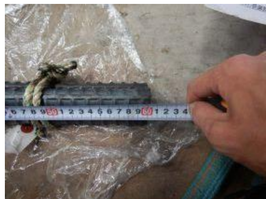
付写真-3.1.4 引張試験片 SD345 D25×L600mm 3本
