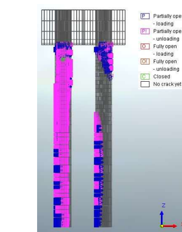
(c) ひび割れコンター図
