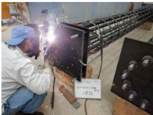
付写真-2.2.12 主鉄筋と①ベースプレートのシール溶接
