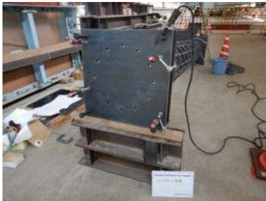
付写真-3.1.9 主鉄筋と①ベースプレートのシール溶接
