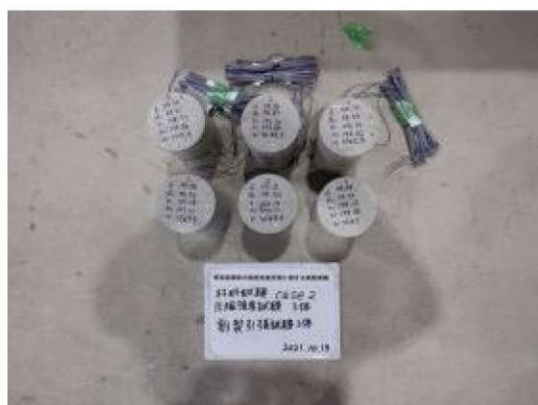
付写真-3.2.16 case2 圧縮・割裂引張強度試験前
