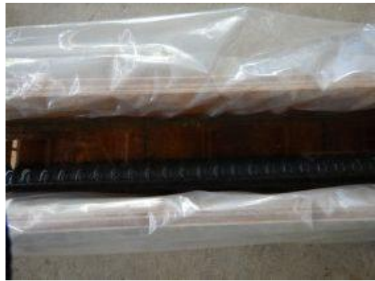
付写真-4.2.4 ねじ切り加工により棒鋼表面に付着した切削油の脱脂
