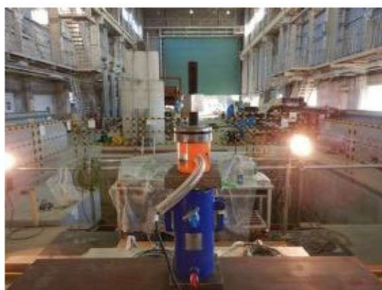
付写真-4.2.214 鉛直載荷ジャッキへの荷重計設置 (1基)
