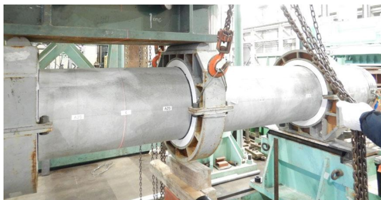
写真-5.3.1.2 治具の設置状況
