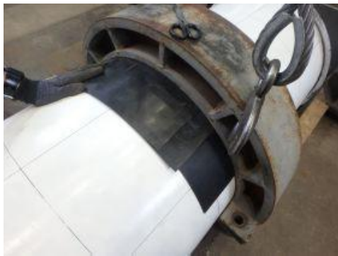
付写真-3.2.6 载荷治具上側の設置
