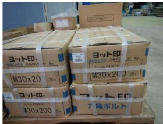
付写真-4. 2. 36 ボルト，ナット一式受入検査
