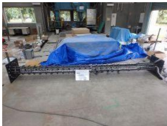
付写真-4.2.51 配筋検査 鉄筋かご 7体目
