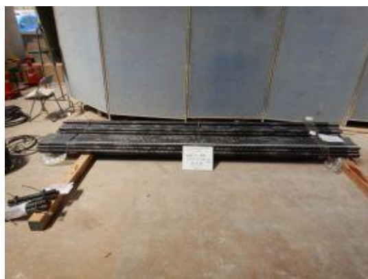
付写真-2.2.2 case3~7 用主鉄筋 SD345D38×L3,800mm 60 本
