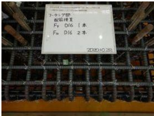
付写真-4.2.147 フーチング供試体配筋検査（一部抜粋）
