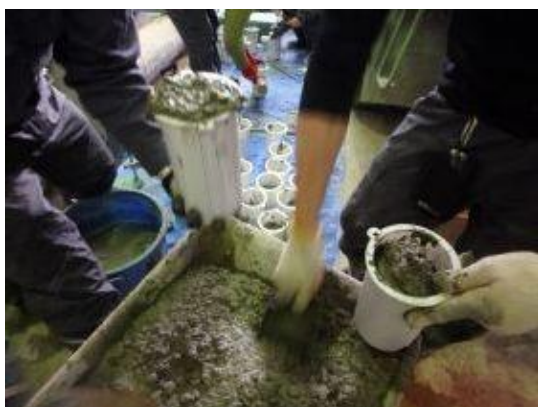
付写真-4. 2. 77 円柱管理供試体の製作
