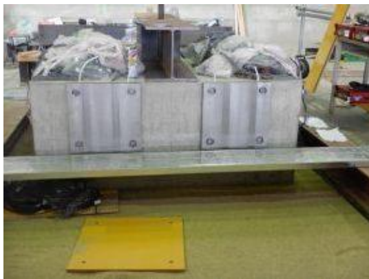
付写真-4. 2. 202 荷点支圧板の設置
