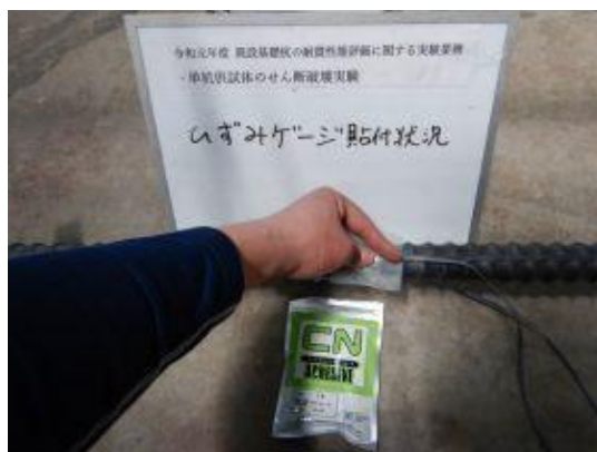
付写真-2.2.17 ひずみゲージの指圧
