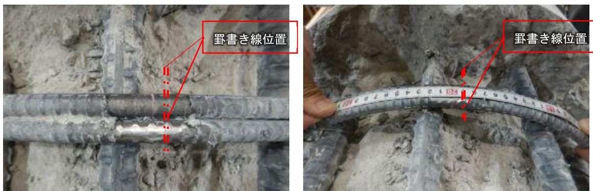
写真-4.2.5.8 2D 継手部はつり調査記録
