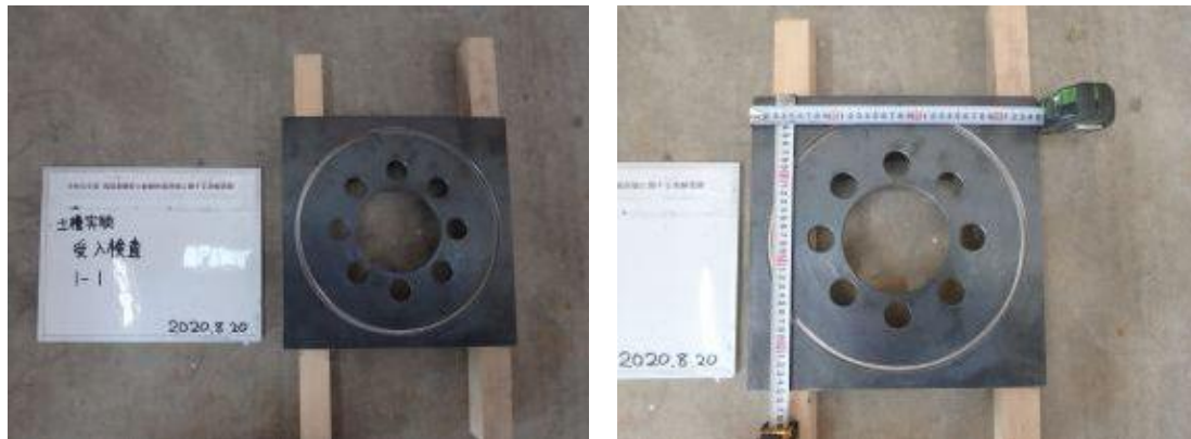
付写真-4.2.18 治具 1-1 受入検査
