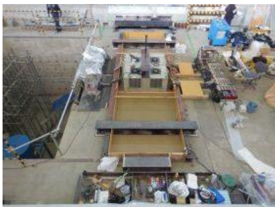
付写真-4. 2. 187 上載荷重の鹿島砂設置
