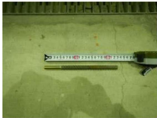
付写真-4. 2. 35 アンカーボルト SD295D13×L230 受入検査
