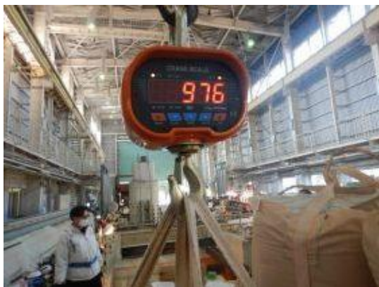
付写真-4. 2. 179 クレーンスケールにて計量
