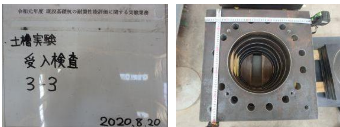
付写真-4.2.20 治具 3-3 受入検査
