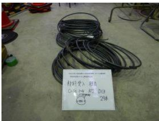
付写真-2.2.6 case1~4 用帯鉄筋 SD295AD13 5\phi + 1\phi 重ね合せ すみ肉溶接 29本
