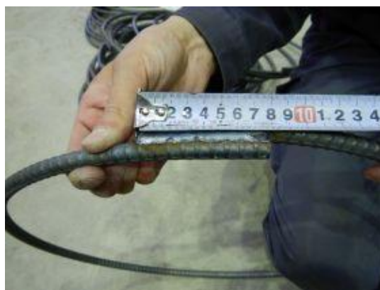
付写真-2.2.6 case1~4 用帯鉄筋 SD295AD13 5\phi + 1\phi 重ね合せ すみ肉溶接 29本
