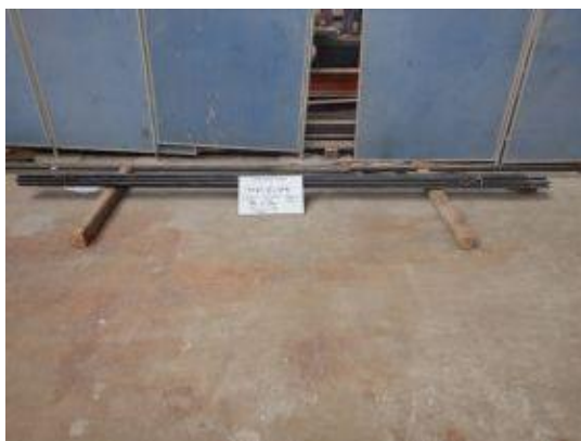
付写真-3.1.2.1 case1 用主鉄筋 SD345 D25×L3800mm 12 本
