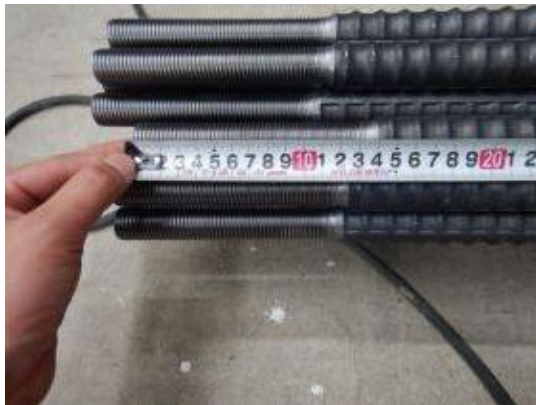
付写真-3.1.3 主鉄筋 SD345 D25 両端ねじ切り加工
