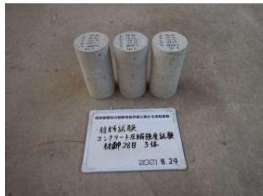
付写真-3.2.11 圧縮強度試験 (σ 28)
