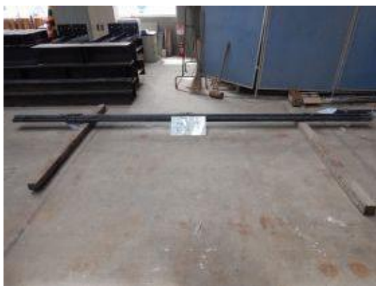
付写真-3.1.2.2 case2 用主鉄筋 SD345 D25×L4700mm 12 本
