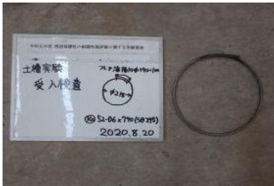
付写真-4.2.5 K 2 SD295A D6×790 (フレア溶接) ×156 本
