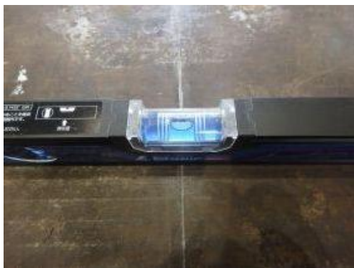
付写真-3.2.8 水準器を用いてレベル確認
