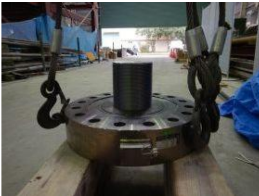
付写真-4.2.130 ロードセル接続ネジの設置
