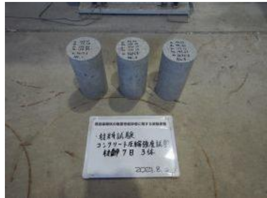
付写真-3.2.9 圧縮強度試験 (σ 7)
