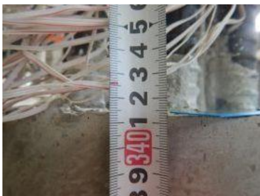
付写真-4. 2. 83 杭供試体の直径計測-03
