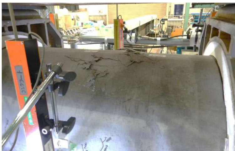
(b) コンクリート圧壊箇所
