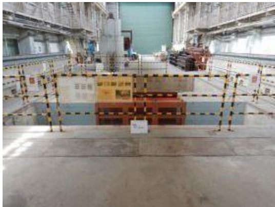
付写真-4. 2. 100 載荷試験に用いる実験土層
