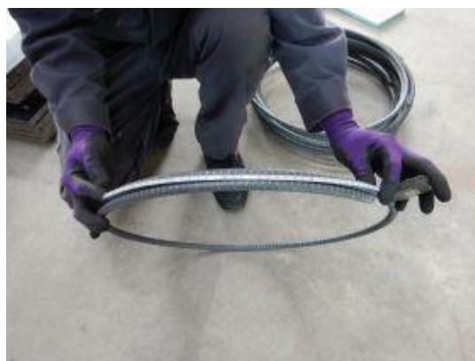
付写真-2.2.5 case5 用帯鉄筋 SD295AD13 重ね継手長 30\phi + 1\phi フックなし 12本
