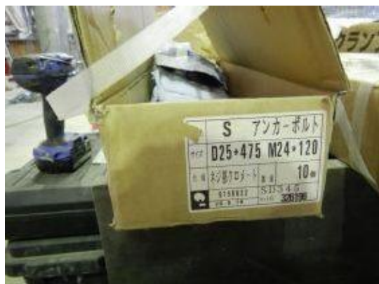
付写真-4. 2. 25 アンカーボルト SD345D25×L475 受入検査
