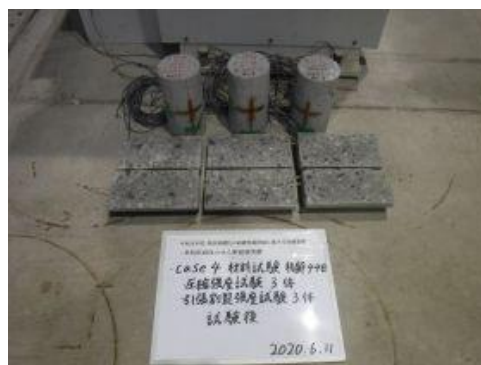
付写真-2.2.73 case4 圧縮・割裂引張強度試験
