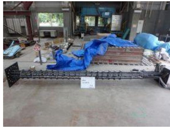
付写真-4.2.45 配筋検査 鉄筋かご 1体目
