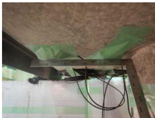
付写真-4.2.172 フーチング底面への土圧計設置
