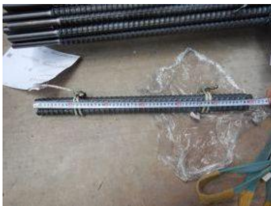
付写真-3.1.4 引張試験片 SD345 D25×L600mm 3本
