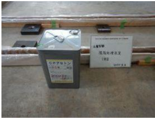
付写真-4.2.4 ねじ切り加工により棒鋼表面に付着した切削油の脱脂
