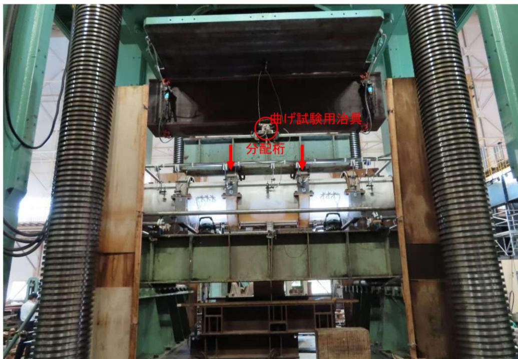
図-4.2.5.9 大型試験機の概要図
