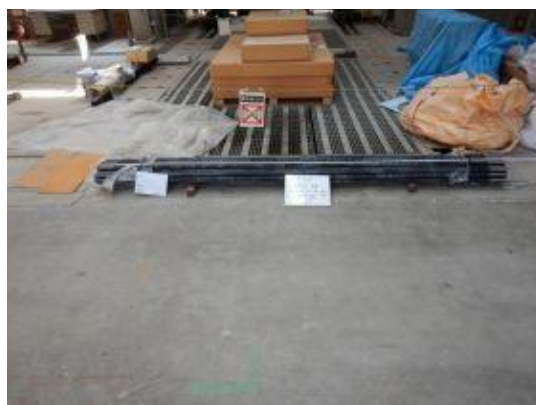
付写真-2.2.1 case1,2 用主鉄筋 SD345D38×L3,340mm 24 本
