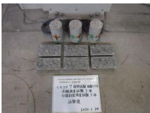
付写真-2.2.76 case7 圧縮・割裂引張強度試験
