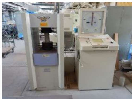
付写真-3.2.12 圧縮強度試験 試験状況
