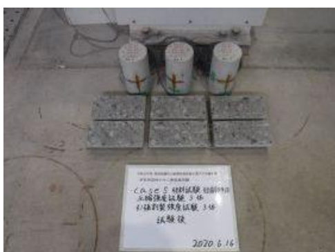
付写真-2.2.74 case5 圧縮・割裂引張強度試験
