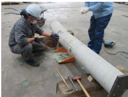
(a) かぶりコンクリートのうき部のはつり状況
