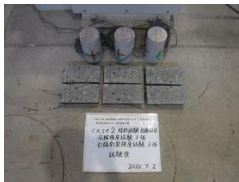
付写真-2.2.71 case2 圧縮・割裂引張強度試験
