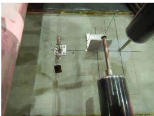
付写真-4.2.216 変位計の設置状況
