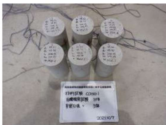
付写真-3.2.14 case1 圧縮・割裂引張強度試験前
