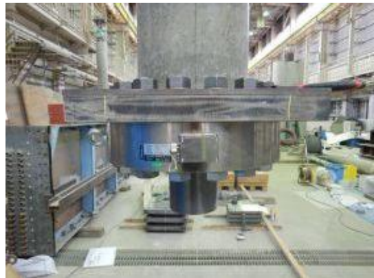
付写真-4.2.131 杭供試体先端への設置
