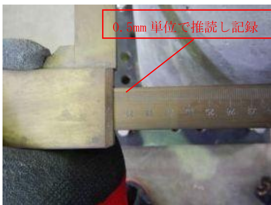
付写真-4. 2. 81 杭供試体の直径計測-03
