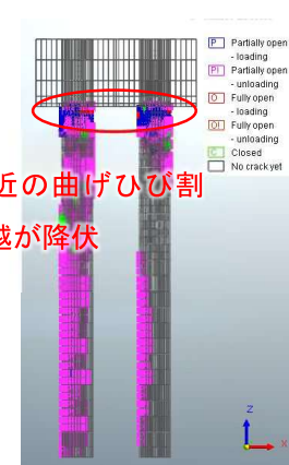
(c) ひび割れコンター図
