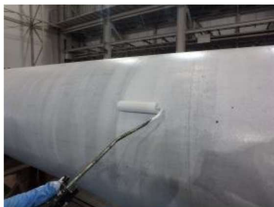
付写真-2.2.61 供試体表面の白化粧施工状況
