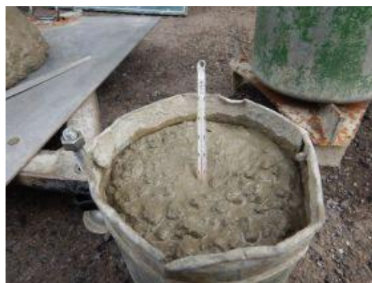
付写真-2.2.48 コンクリート温度測定値
