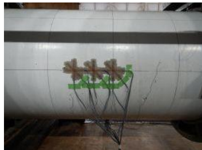
付写真-2.2.64 コンクリートひずみゲージの設置状況
