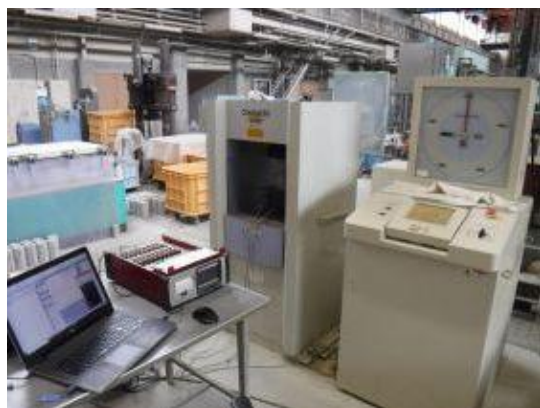
付写真-2. 2. 68 試験状況（圧縮強度）
