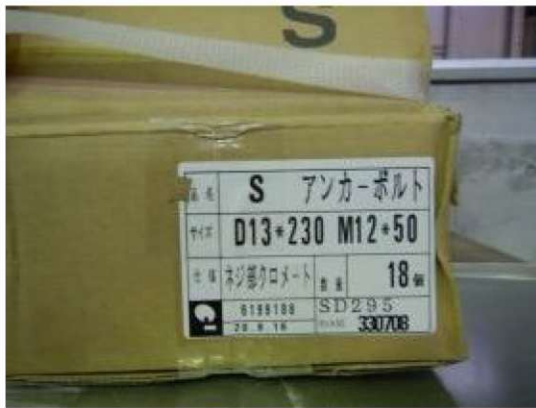
付写真-4. 2. 35 アンカーボルト SD295D13×L230 受入検査
