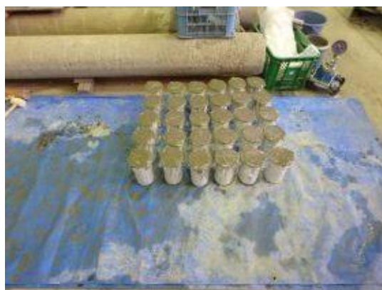
付写真-4. 2. 77 円柱管理供試体の製作
