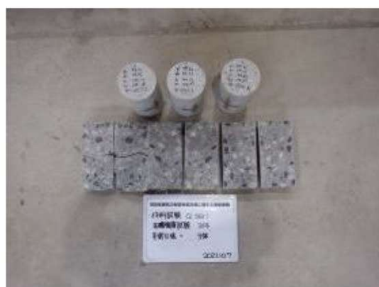
付写真-3.2.15 case1 圧縮・割裂引張強度試験後
