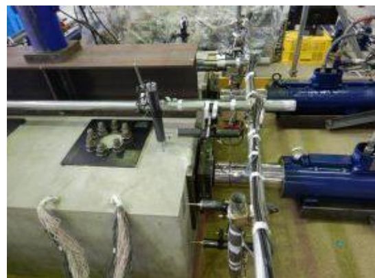
付写真-4. 2. 205 荷点治具の設置
