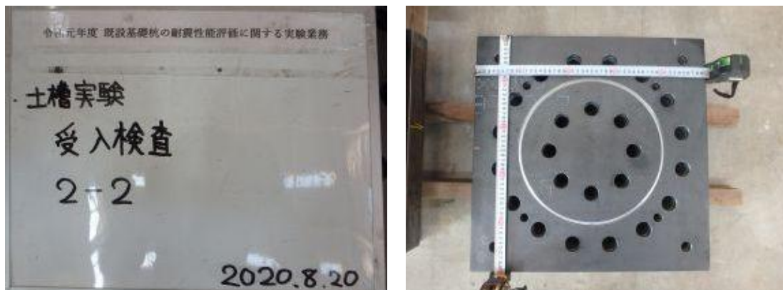
付写真-4.2.19 治具 2-2 受入検査
