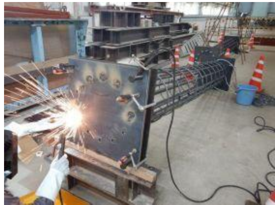
付写真-3.1.9 主鉄筋と①ベースプレートのシール溶接
