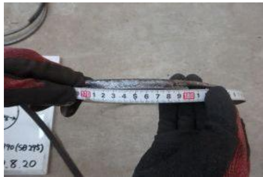
付写真-4.2.5 K 2 SD295A D6×790 (フレア溶接) ×156 本
