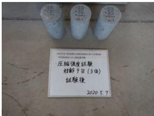
付写真-2.2.65 圧縮強度試験（σ 9 ）
