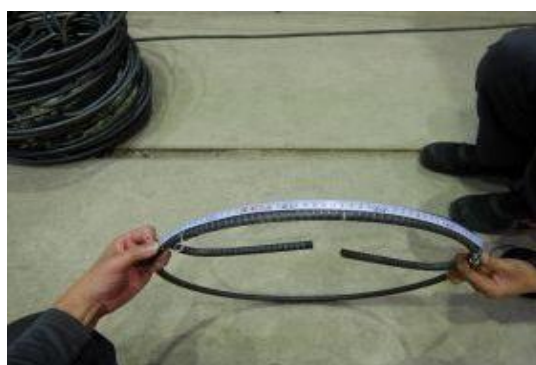
付写真-2.2.7 case6~8 用帯鉄筋 SD295AD13 重ね継手長 40\phi + 1\phi 50本
