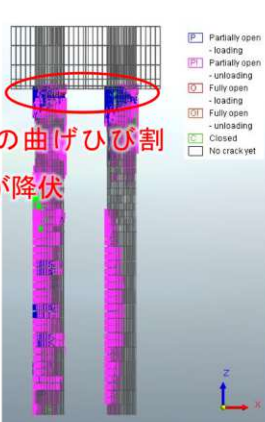
(c) ひび割れコンター図
