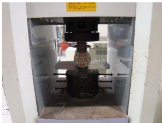
付写真-2. 2. 69 試験状況（割裂引張強度）
