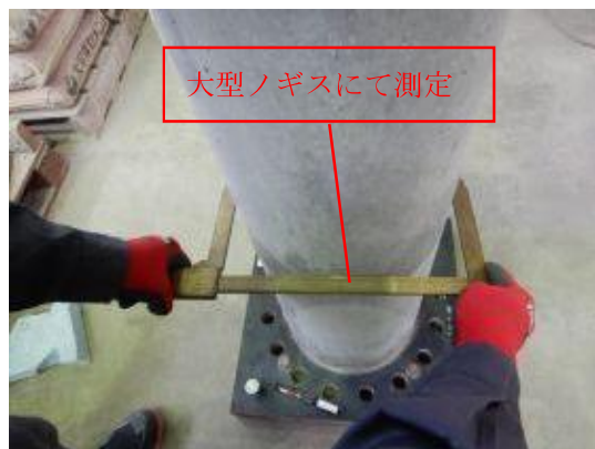
付写真-4. 2. 80 杭供試体の直径計測状況-02
