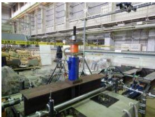
付写真-4. 2. 204 鉛直荷点ジャッキの設置
