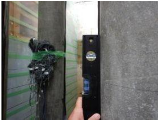
付写真-4. 2. 134 杭供試体の建ち確認
