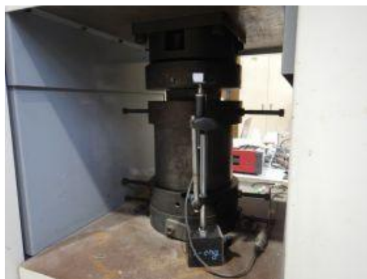
付写真-3.2.21 変位計セット状況
