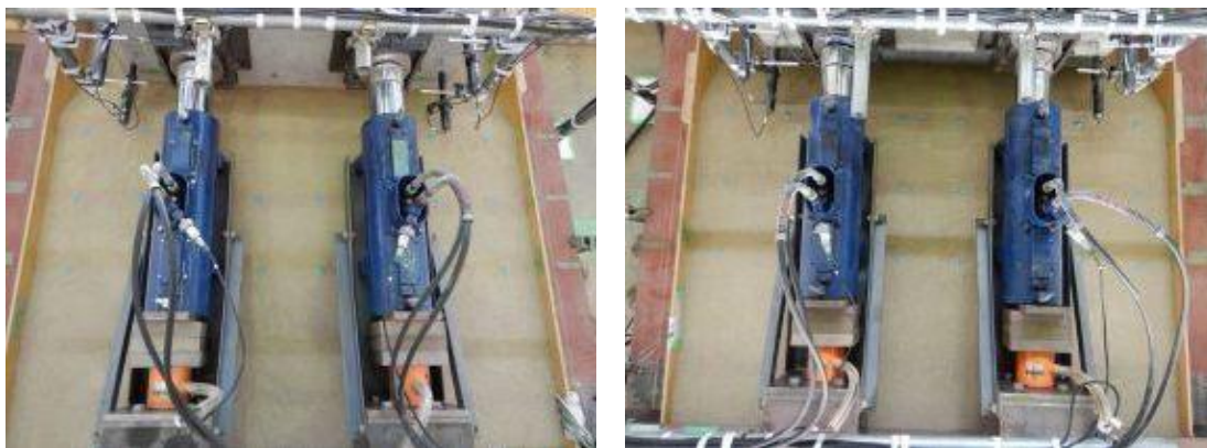
付写真-4.2.215 水平载荷ジャッキへの荷重計設置 (4基)
