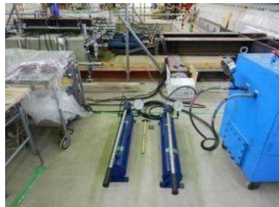
付写真-4. 2. 203 水平荷点ジャッキの設置
