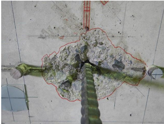
写真-7.3.2.3 表面のコーン破壊
