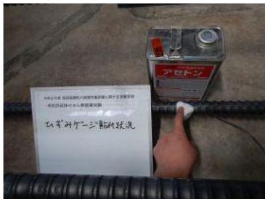
付写真-2.2.15 アセトンによる脱脂
