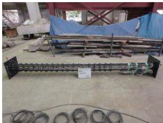
付写真-4.2.55 配筋検査 鉄筋かご 11 体目
