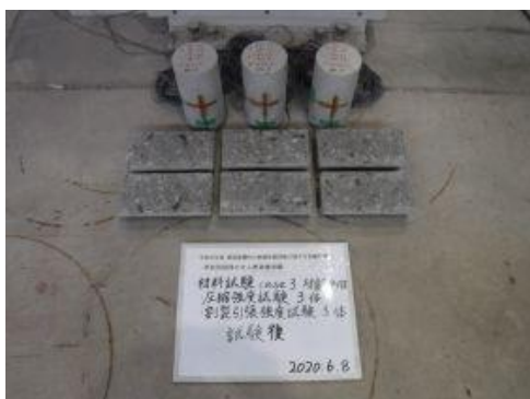
付写真-2.2.72 case3 圧縮・割裂引張強度試験
