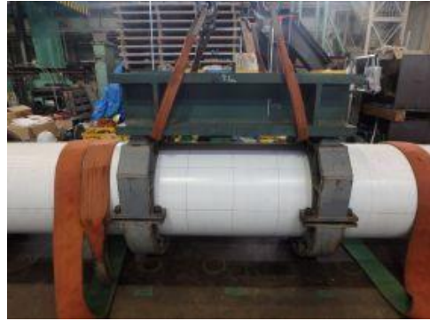
付写真-3.2.7 载荷分配桁の設置
