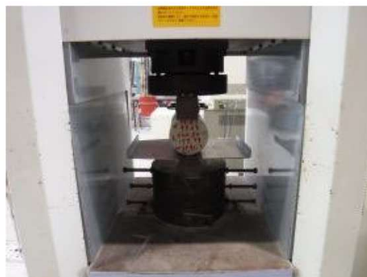
付写真-3.2.13 割裂引張強度試験 試験状況
