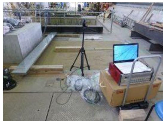
付写真-4. 2. 209 加速度計の板叩き法による計測状況 (case3)
