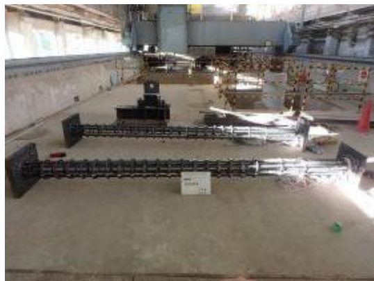
付写真-4.2.49 配筋検査 鉄筋かご 5体目
