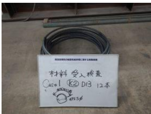
付写真-3.1.5.2 SD295 D13 帯鉄筋 重ね継手長 30φ case1 12本、case2 15本
