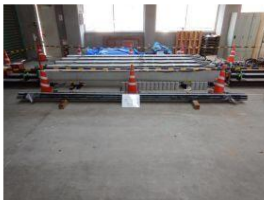
付写真-2.2.3 case8 用主鉄筋 SD345D38×L4,700mm 12 本
