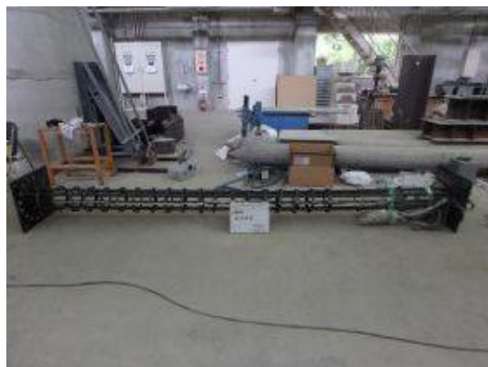
付写真-4.2.54 配筋検査 鉄筋かご 10 体目
