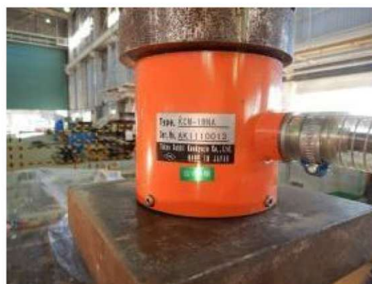
付写真-4.2.214 鉛直載荷ジャッキへの荷重計設置 (1基)
