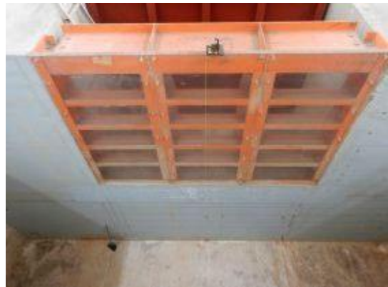
付写真-4. 2. 101 実験土層の位置出し-01
