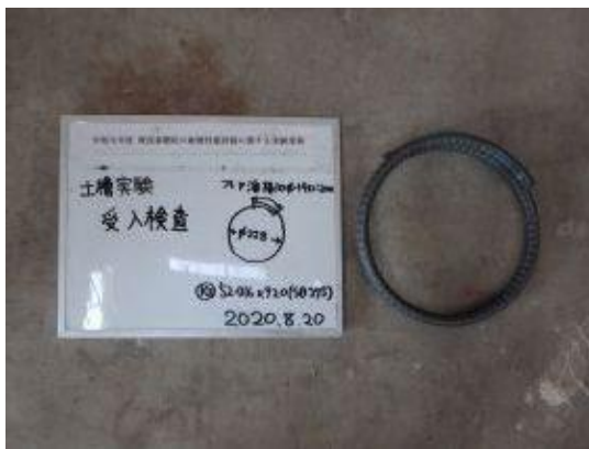
付写真-4.2.6 K 3 SD295A D16×920 (フレア溶接) ×228 本
