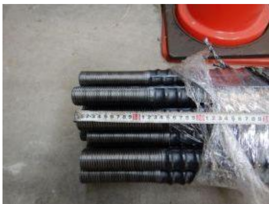
付写真-2.2.4 主鉄筋 SD345D38 両端ねじ切り加工
