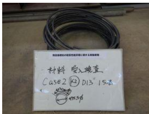
付写真-3.1.5.2 SD295 D13 帯鉄筋 重ね継手長 30φ case1 12本、case2 15本
