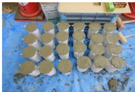
付写真-3.1.47 円柱供試体作製-02
