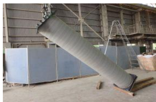
付写真-2.2.60 供試体の横倒し状況
