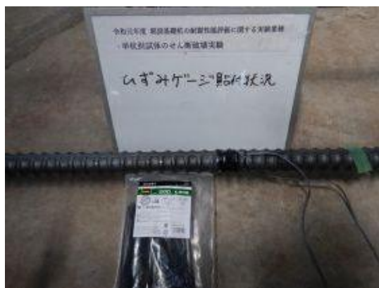
付写真-2.2.20 ロックタイを用いてVMテープの両端を防水結束
