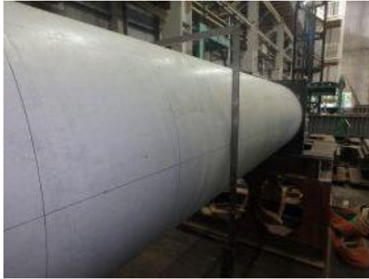
付写真-2.2.62 出来形管理供試体直径測定状況（鉛直方向）
