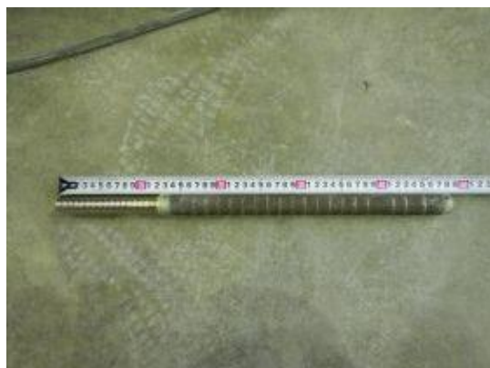
付写真-4. 2. 25 アンカーボルト SD345D25×L475 受入検査
