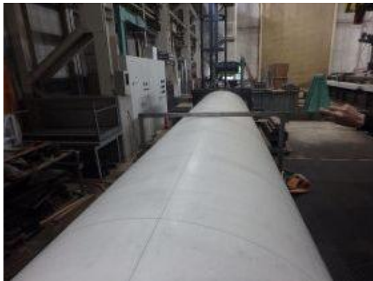
付写真-2.2.63 出来形管理供試体直径測定状況（水平方向）
