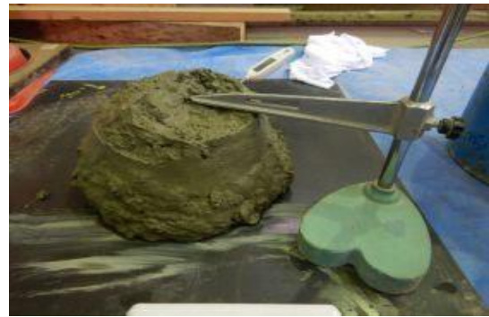
付写真-3.1.37 スランプ・Co 温度試験測定値
