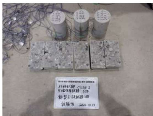
付写真-3.2.17 case2 圧縮・割裂引張強度試験後
