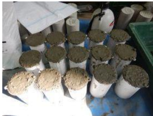
付写真-4. 2. 160 円柱管理供試体の製作
