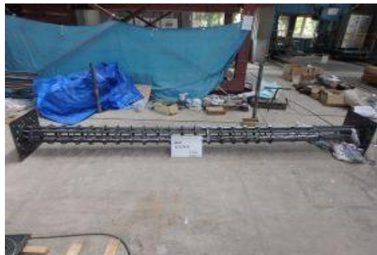
付写真-4.2.52 配筋検査 鉄筋かご 8体目
