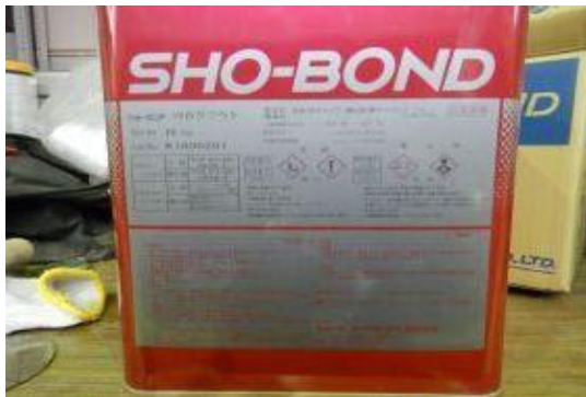
付写真-4. 2. 113 アンカーボルトに用いたエポキシ樹脂 WB グラウト (株)ショーボンドマテリアル
