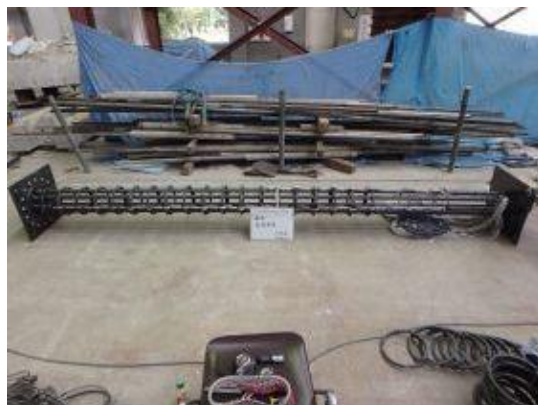
付写真-4.2.50 配筋検査 鉄筋かご 6体目
