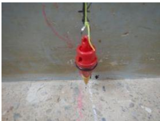
付写真-4. 2. 102 実験土層の位置出し-02
