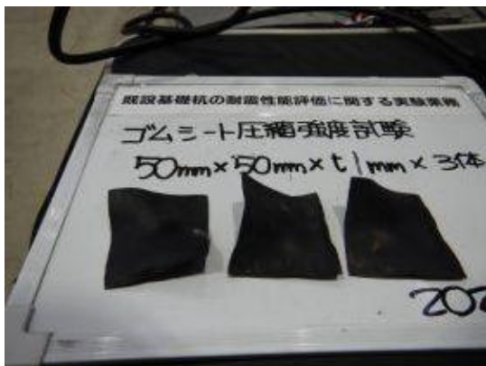
付写真-3.2.22 ゴム板圧縮試験後状況
