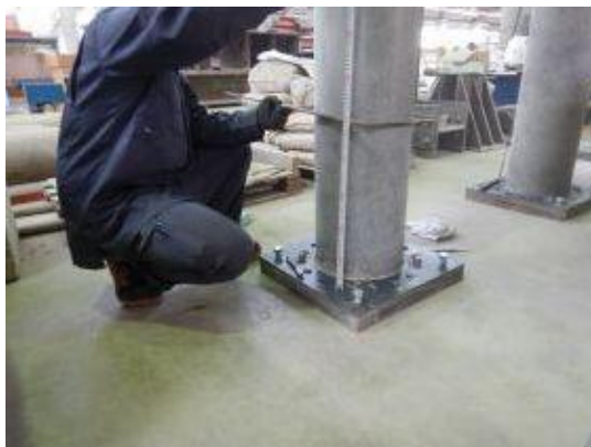
付写真-4. 2. 79 杭供試体の直径計測-01
