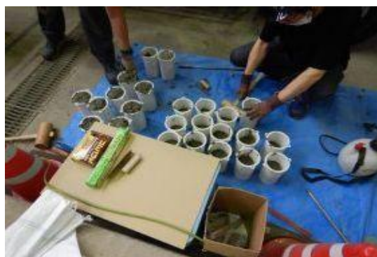
付写真-3.1.46 円柱供試体作製-01
