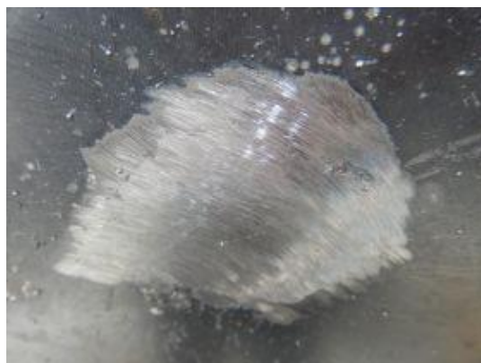
付写真-2.2.13 シール溶接部の平滑化処理
