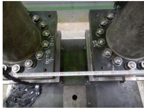
付写真-4. 2. 135 杭の中心間隔 2. 5D の確認
