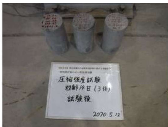
付写真-2.2.66 圧縮強度試験 ( \sigma_{14} )
