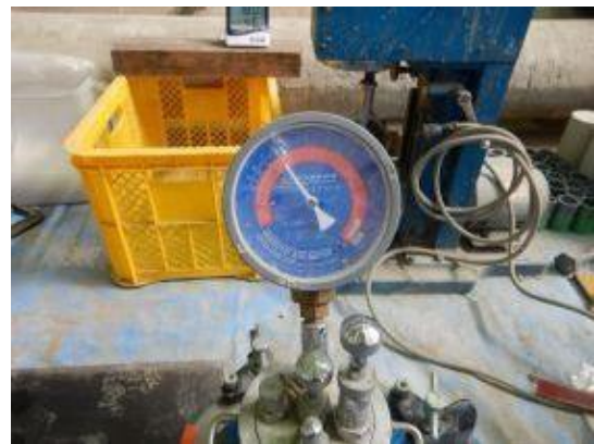
付写真-4. 2. 151 空気量試験測定値
