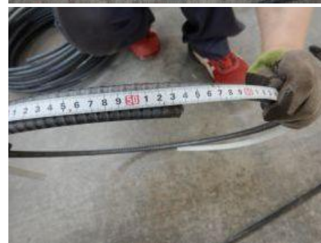
付写真-3.1.5.1 SD295 D13 帯鉄筋 重ね継手長 30φ×27本、引張試験片 3本
