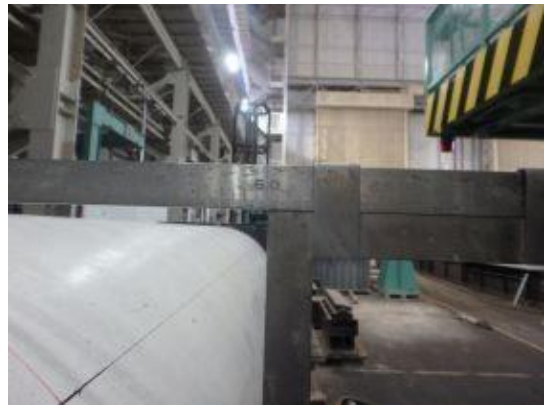
付写真-2.2.63 出来形管理供試体直径測定状況（水平方向）
