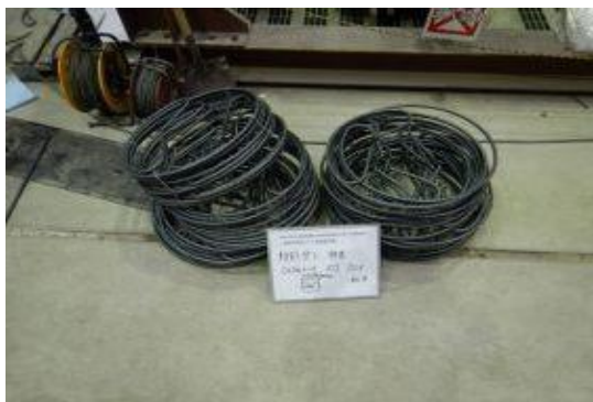
付写真-2.2.7 case6~8 用帯鉄筋 SD295AD13 重ね継手長 40\phi + 1\phi 50本
