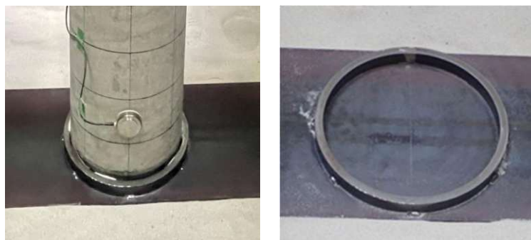
写真-3.3.4.2 杭先端の治具
