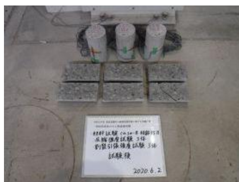
付写真-2.2.77 case8 圧縮・割裂引張強度試験
