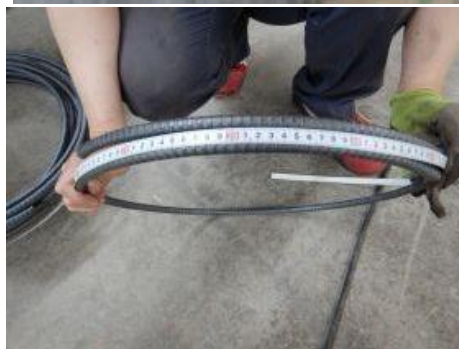
付写真-3.1.5.1 SD295 D13 帯鉄筋 重ね継手長 30φ×27本、引張試験片 3本
