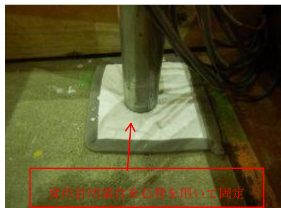
付写真-4.2.216 変位計の設置状況
