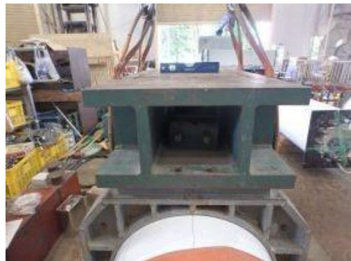
付写真-3.2.8 水準器を用いてレベル確認
