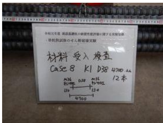
付写真-2.2.3 case8 用主鉄筋 SD345D38×L4,700mm 12 本
