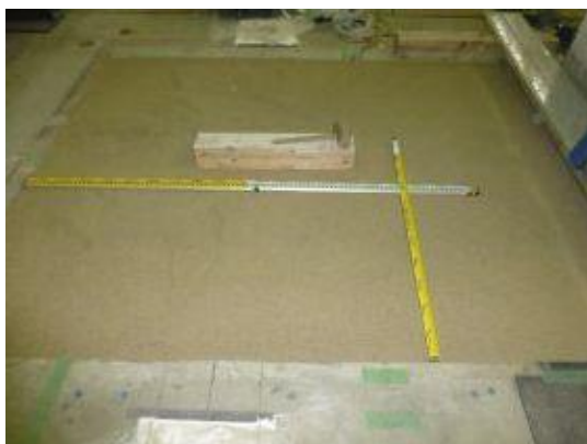
付写真-4. 2. 209 加速度計の板叩き法による計測状況 (case3)
