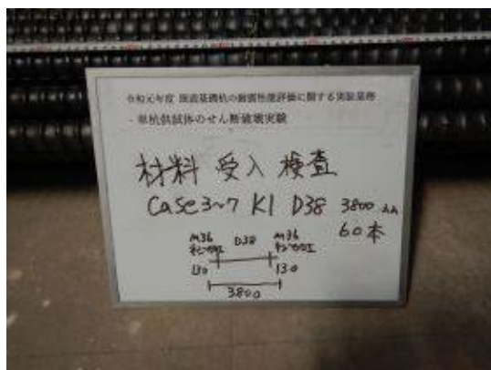
付写真-2.2.2 case3~7 用主鉄筋 SD345D38×L3,800mm 60 本
