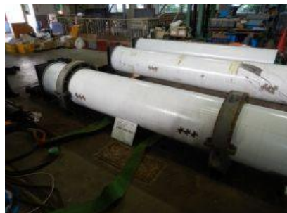
付写真-2.2.64 コンクリートひずみゲージの設置状況
