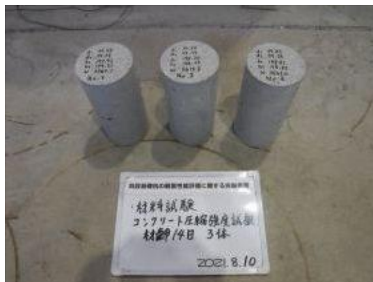
付写真-3.2.10 圧縮強度試験 (σ 14)
