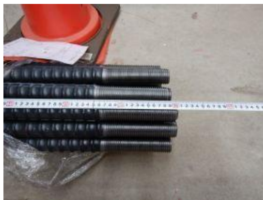
付写真-2.2.4 主鉄筋 SD345D38 両端ねじ切り加工
