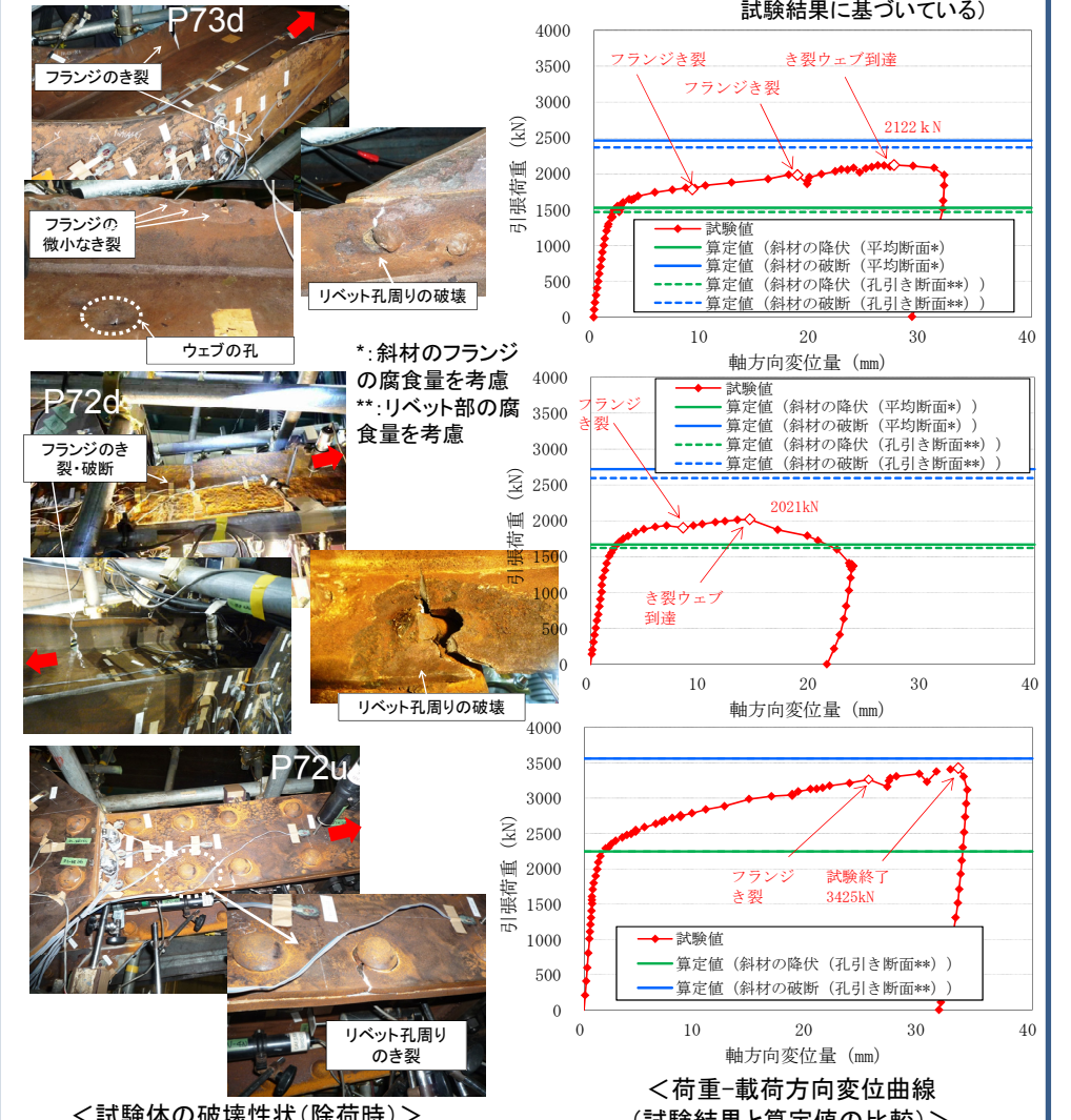
＜試験体の破壊性状(除荷時)＞
