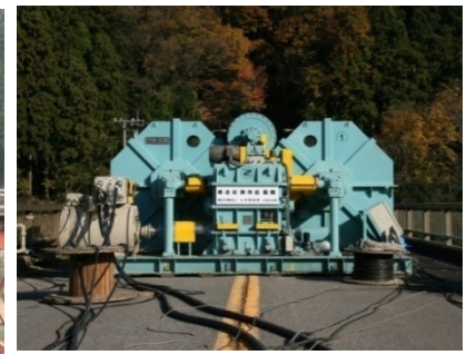
起振機による振動試験
