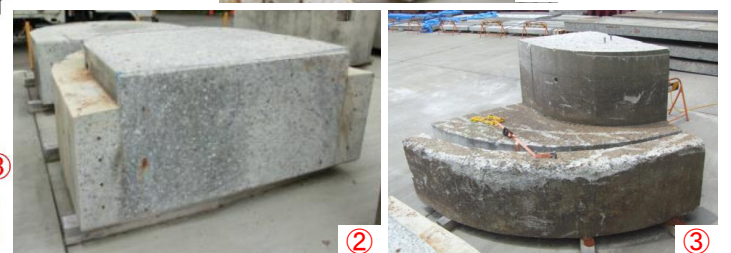
②③ RC巻立て(柱部・基部) (2005年施工・約7年経過)
