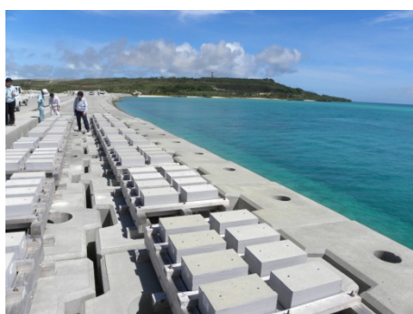
現地暴露供試体(181体) 実際の下部工に使ったコンクリートと同じ材料・同じ配合
