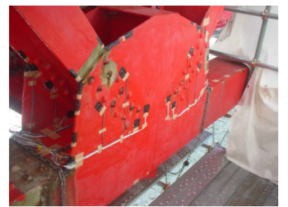
ひずみゲージ貼付状況
