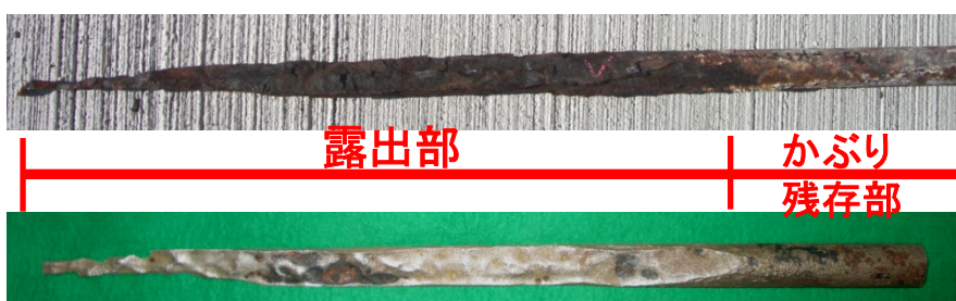
除錆前後の鉄筋状況
