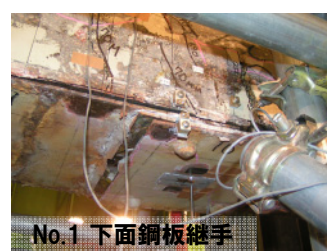
載荷試験後の破壊状況
