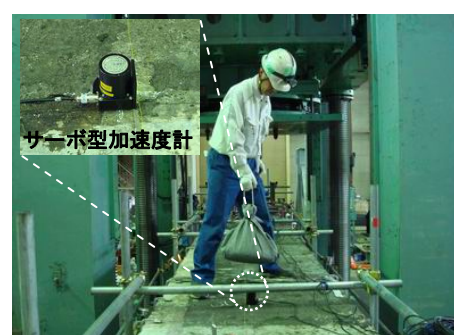
振動計測(砂袋による加振)
