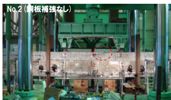
載荷試験後の破壊状況
