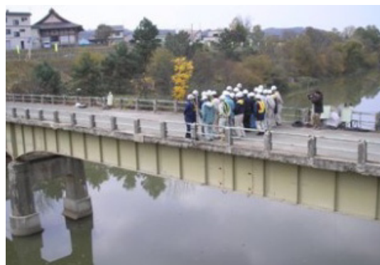
人力加振による振動試験
