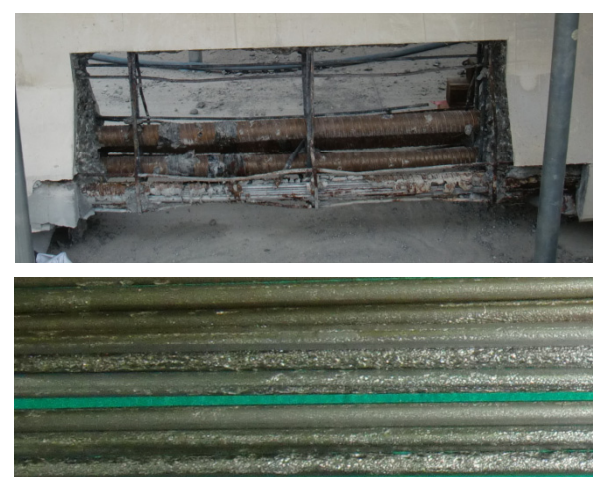
撤去桁下桁の解体調査 PC鋼線の腐食による断面減少の状況
