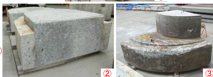
②③ RC巻立て(柱部・基部) (2005年施工・約7年経過)
