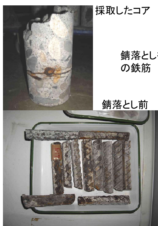
撤去橋脚の鉄筋の腐食程度
