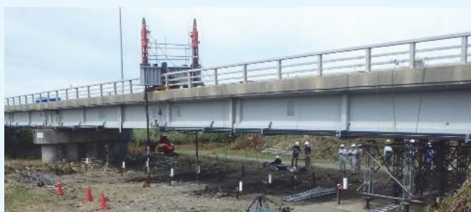
撤去予定橋梁の破壊までの現地载荷試験
