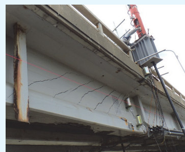
撤去予定橋梁の破壊までの現地载荷試験
